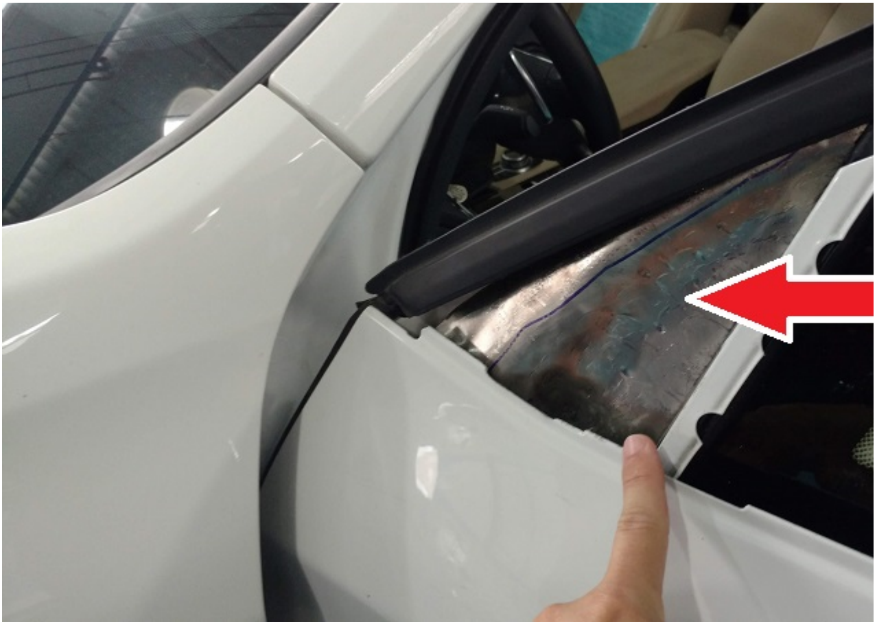
Figura 11 - Chapa de aço inox aplicada na região do retrovisor externo.
