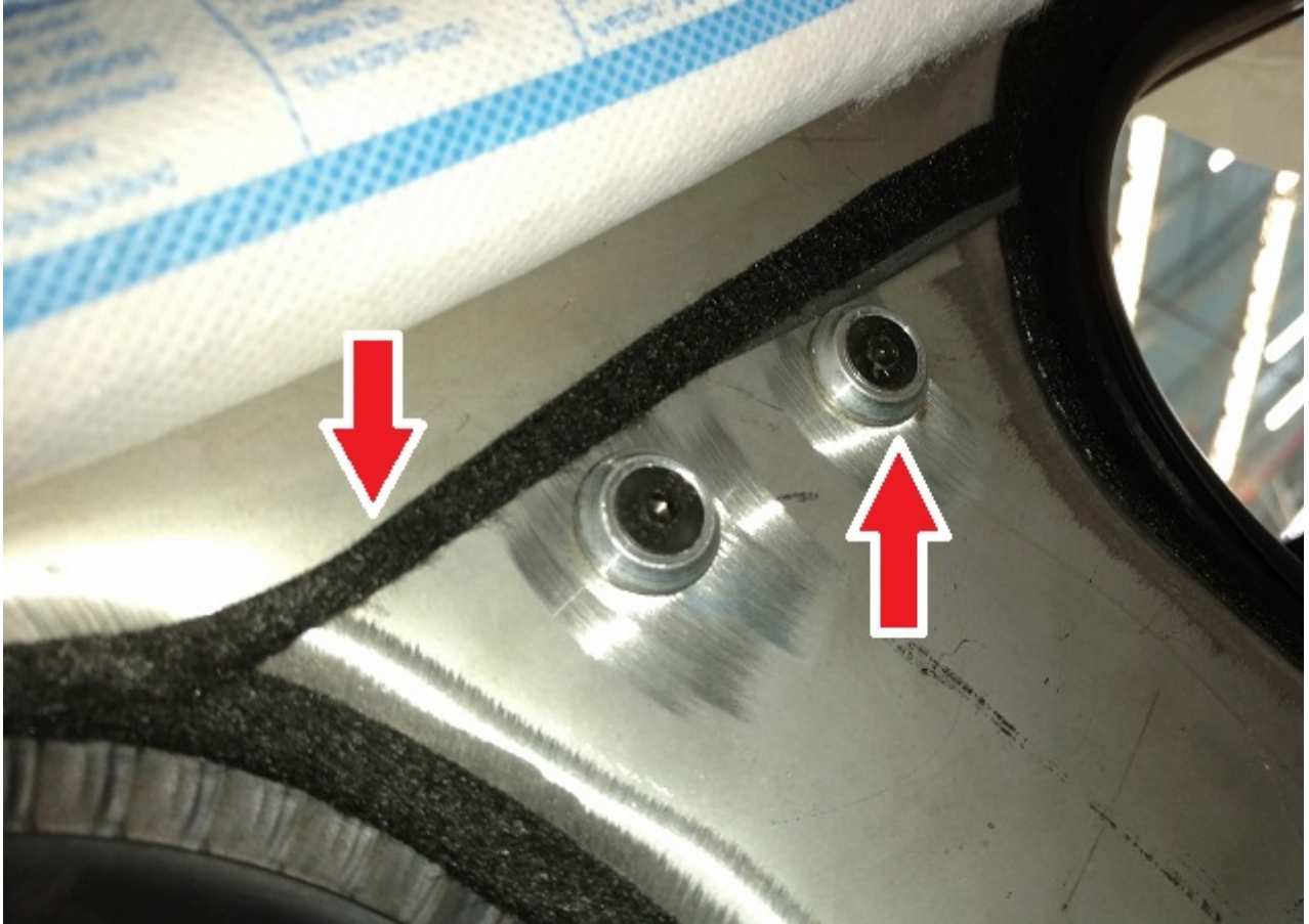
Figura 1 - Detalhe da fixação das chapas de aço inox no interior do veículo com rebites de rosca e da fita de feltro.
