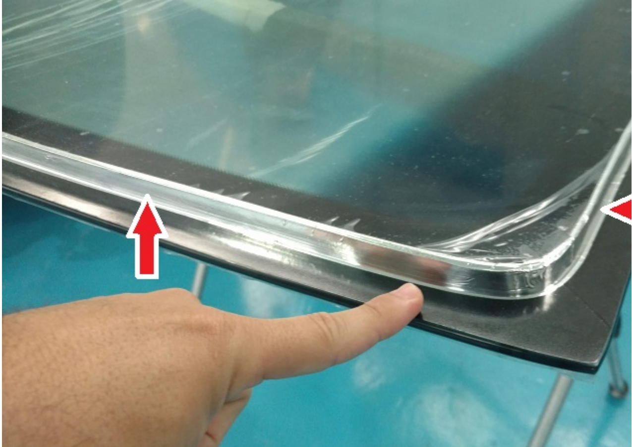
Figura 8 - Fita de alumínio aplicada à lateral do pacote de forma a evitar a contaminação das lâminas.
