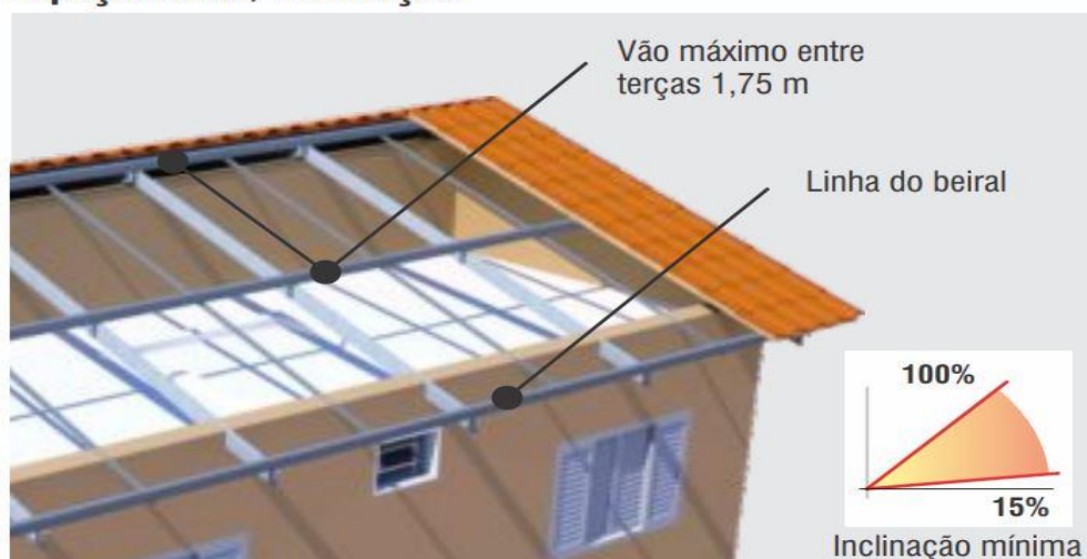
Figura 05: Instalação de telhas cerâmicas
