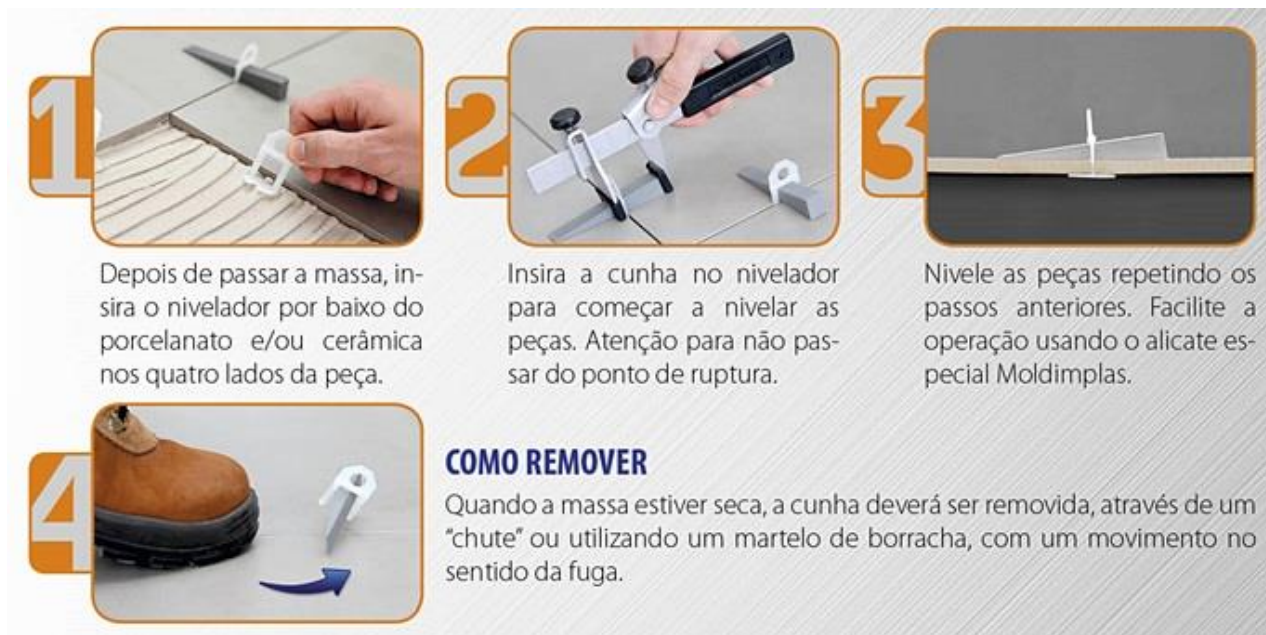
Figura 09: Nivelamento porcelanato
