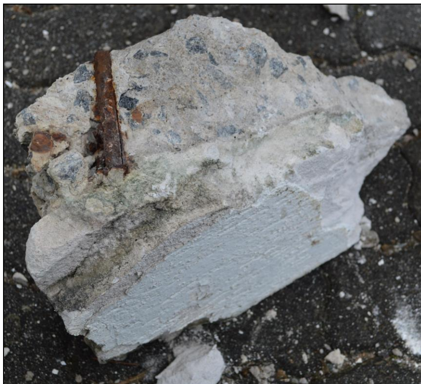
Fotografia 3 - Pedaco de concreto e argamassa desprendido do local danificado
