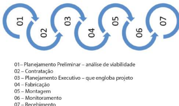
Figura 7: Etapas do processo construtivo industrializado
