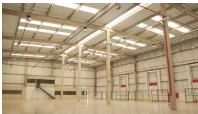
Figura 80: Cobertura com telhas metálicas para vãos menores
