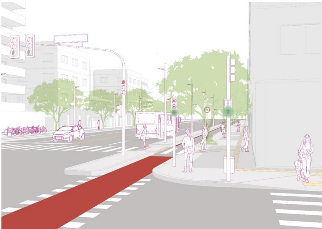
Figura 50 - Semaforização para pedestres e ciclistas em interseção de via arterial bidirecional com ciclovia e grande circulação de pedestres.
