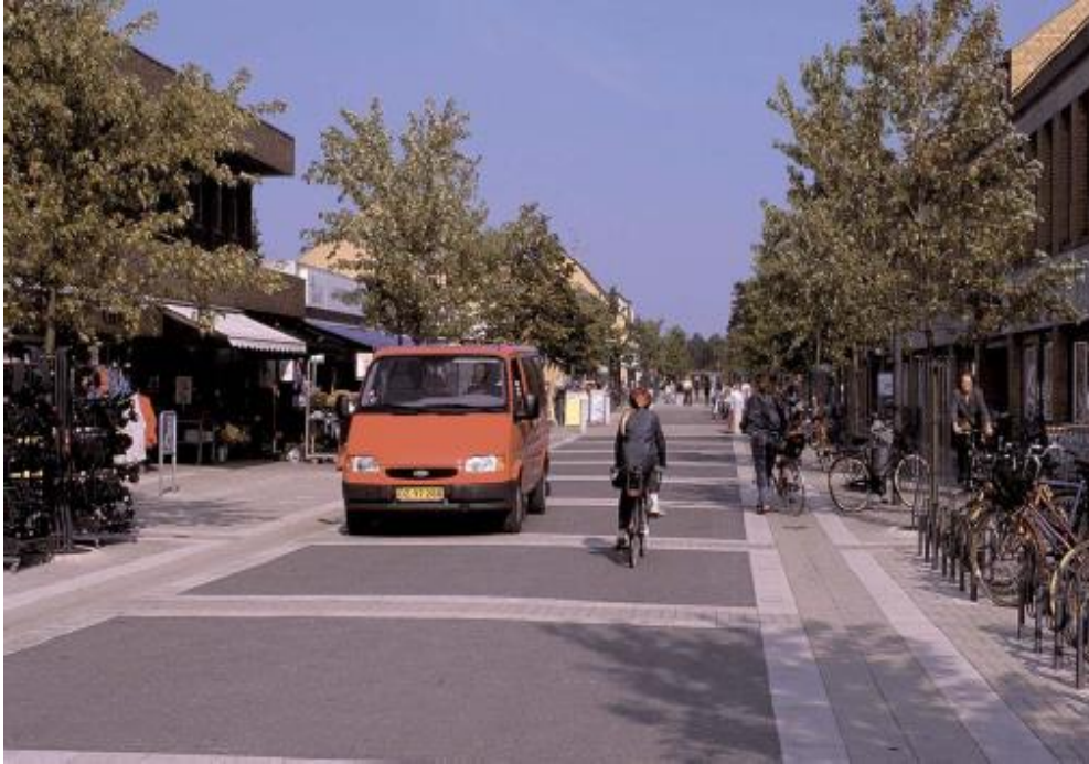
Figura 49 - Elementos verticais no bordo da via e no pavimento induzem os motoristas a dirigir em velocidades mais baixas. Fonte: Danish Roads Standards, 2013.
