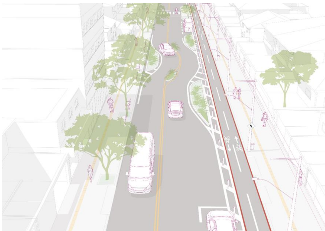
Figura 18 - Chicanas implantadas em via bidirecional em área predominante residencial.
