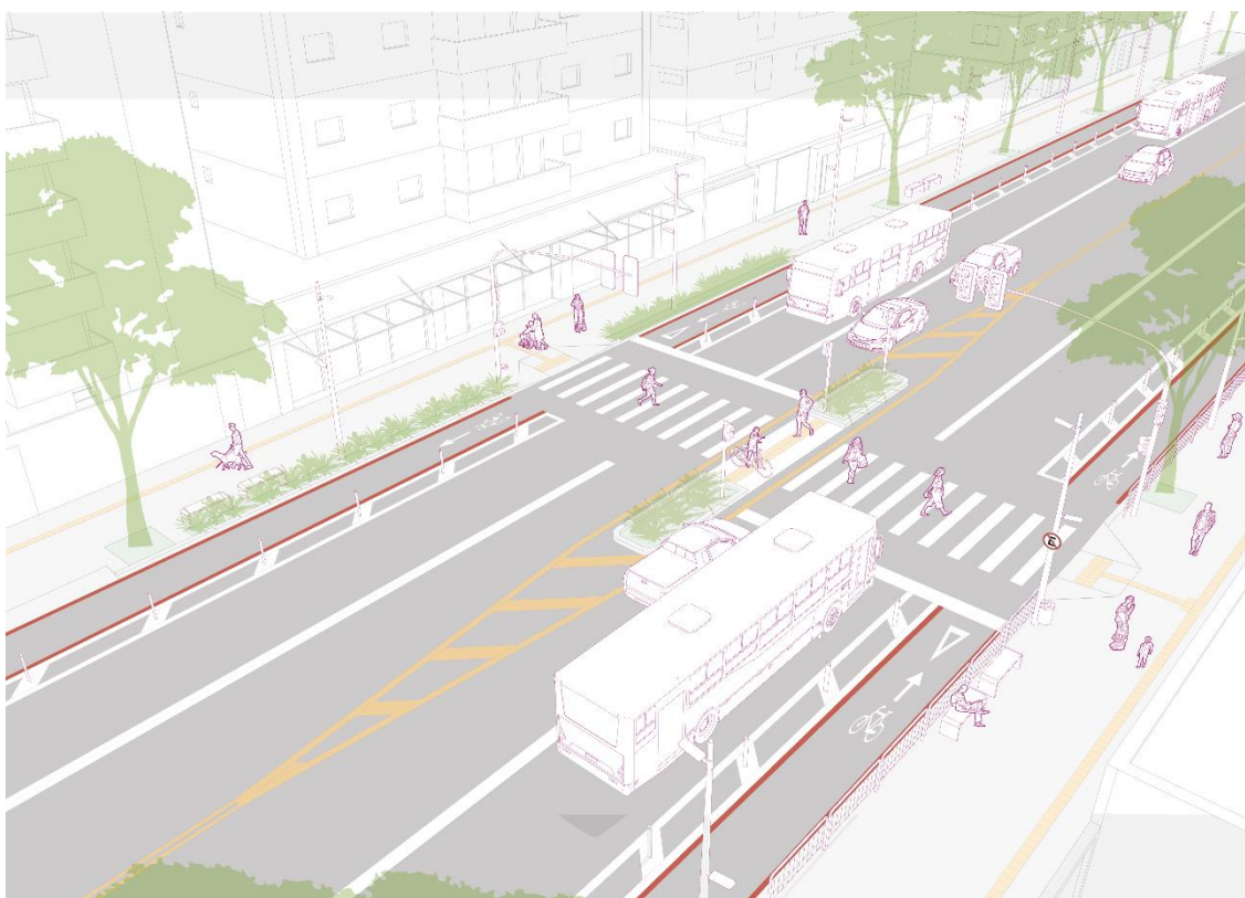
Figura 27 - Ilha de refúgio para pedestres implantada em via arterial bidirecional com presença de ciclovia unidirecional em cada bordo e faixa exclusiva para transporte coletivo.
