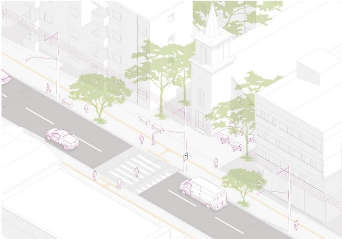
Figura 6 - Faixa elevada para travessia de pedestres implantada em via coletora unidirecional em área de uso misto.
