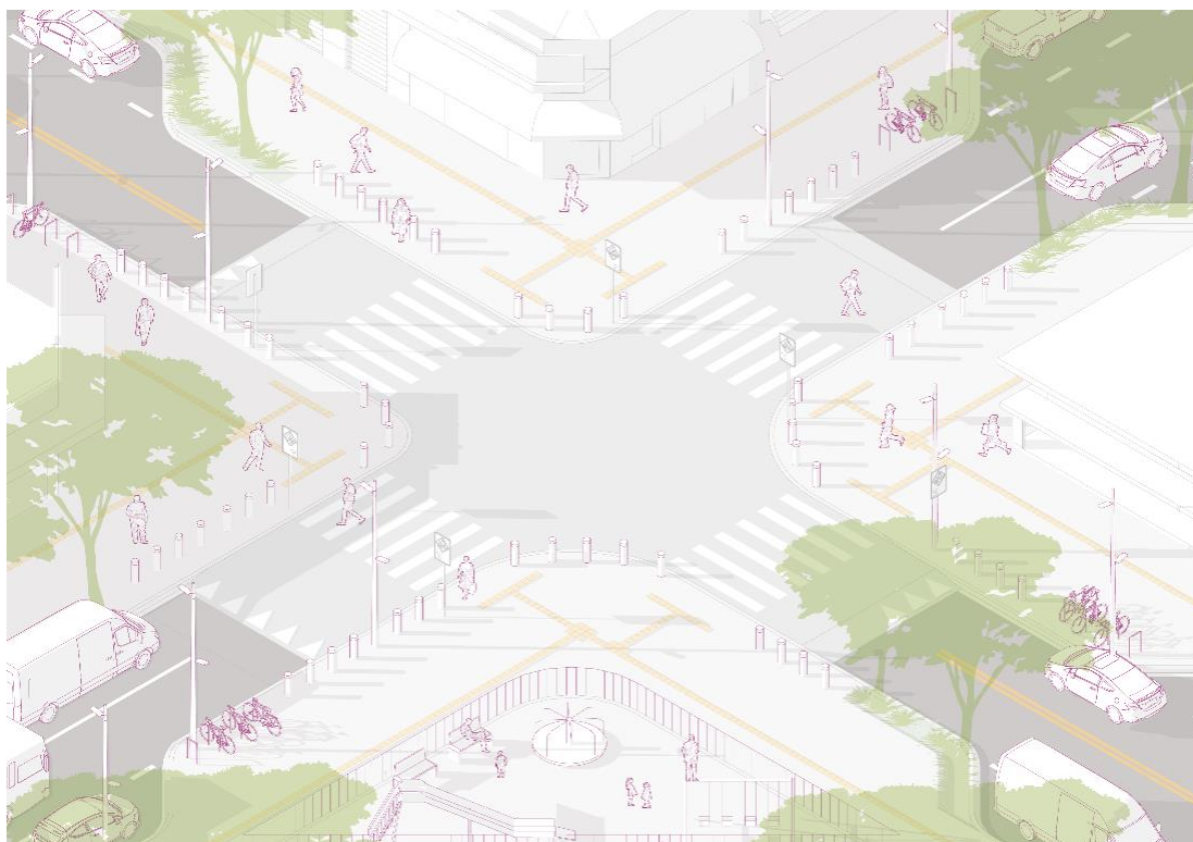
Figura 10 - Interseção elevada implantada em conjunto com extensões de meio-fio nas quatro aproximações de vias bidirecionais e unidirecionais.
