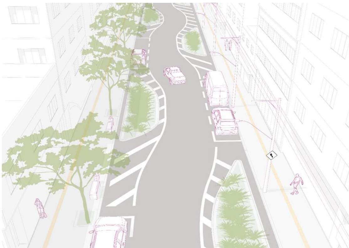
Figura 19 - Chicanas implantadas em via unidirecional em área predominante residencial.
