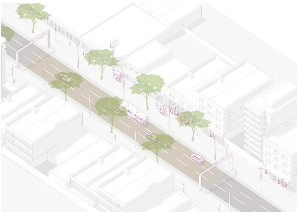
Figura 54 - Radares para medição da velocidade média em trecho de via arterial unidirecional em área de uso misto.
