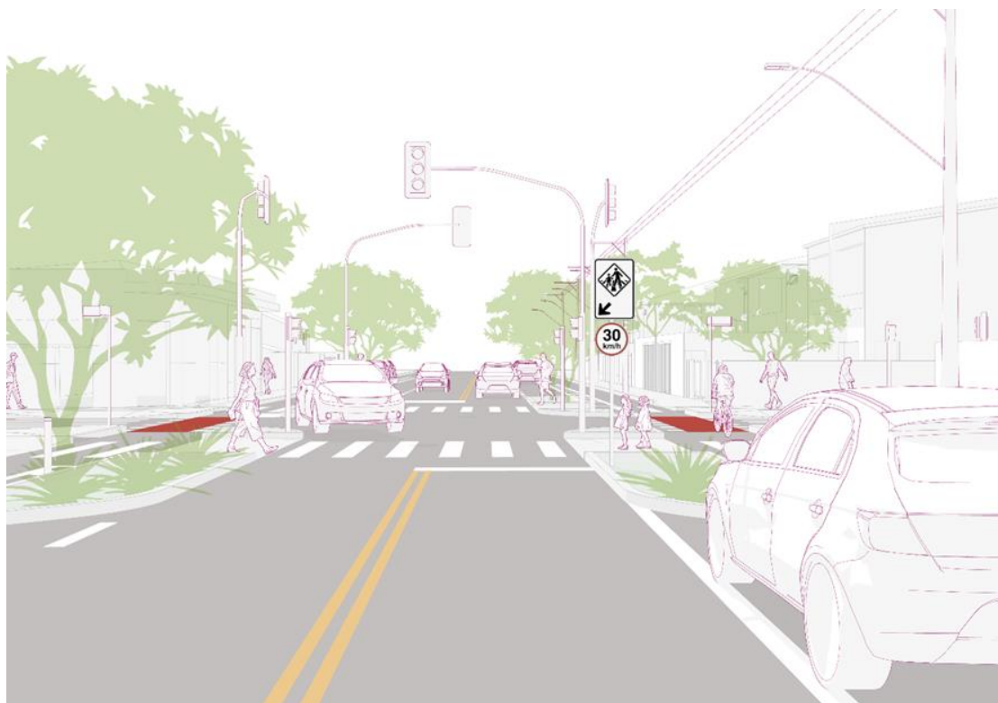
Figura 14 - DEPOIS: Via bidirecional com extensões de meio-fio, estacionamento e paisagismo em via de menor velocidade com a presença de ciclovia unidirecional em cada bordo em área de uso misto.
