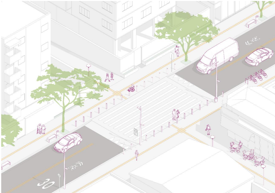
Figura 9 - Platô implantado em via bidirecional de 30 km/h com presença de ciclorrota e em área de uso misto.
