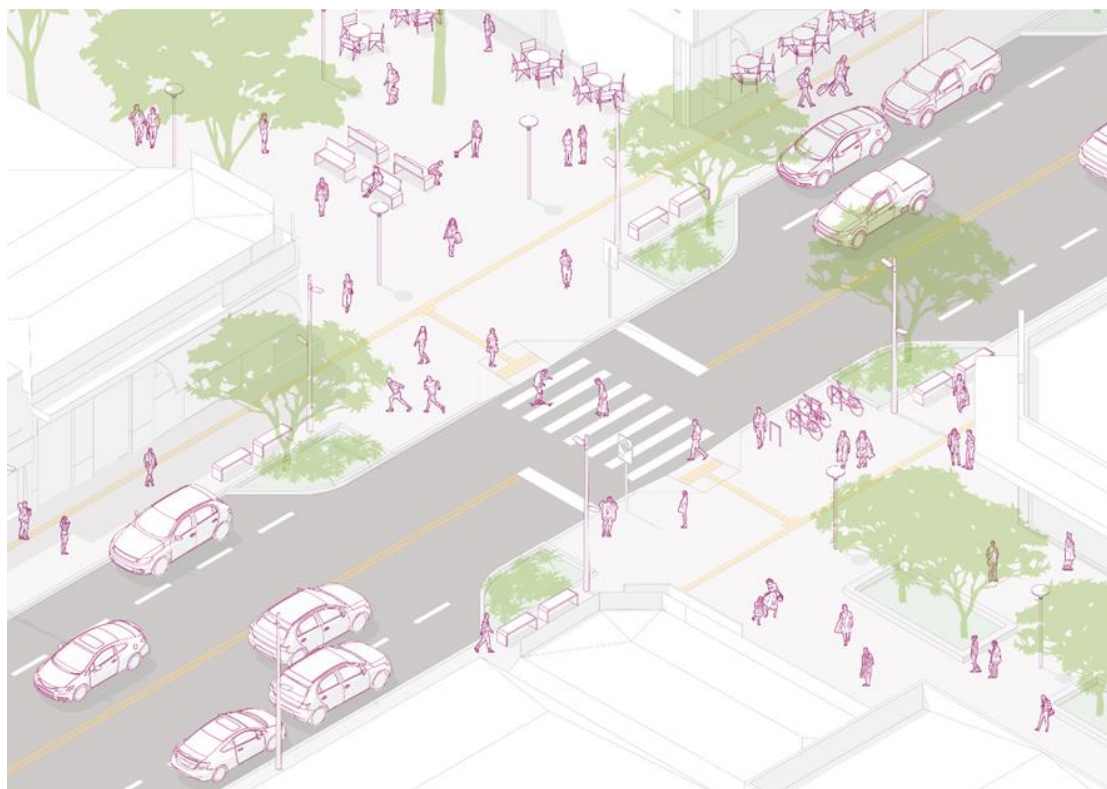
Figura 30 - Afunilamento em meio de quadra implantado em via coletora bidirecional em área predominantemente comercial e de lazer.
