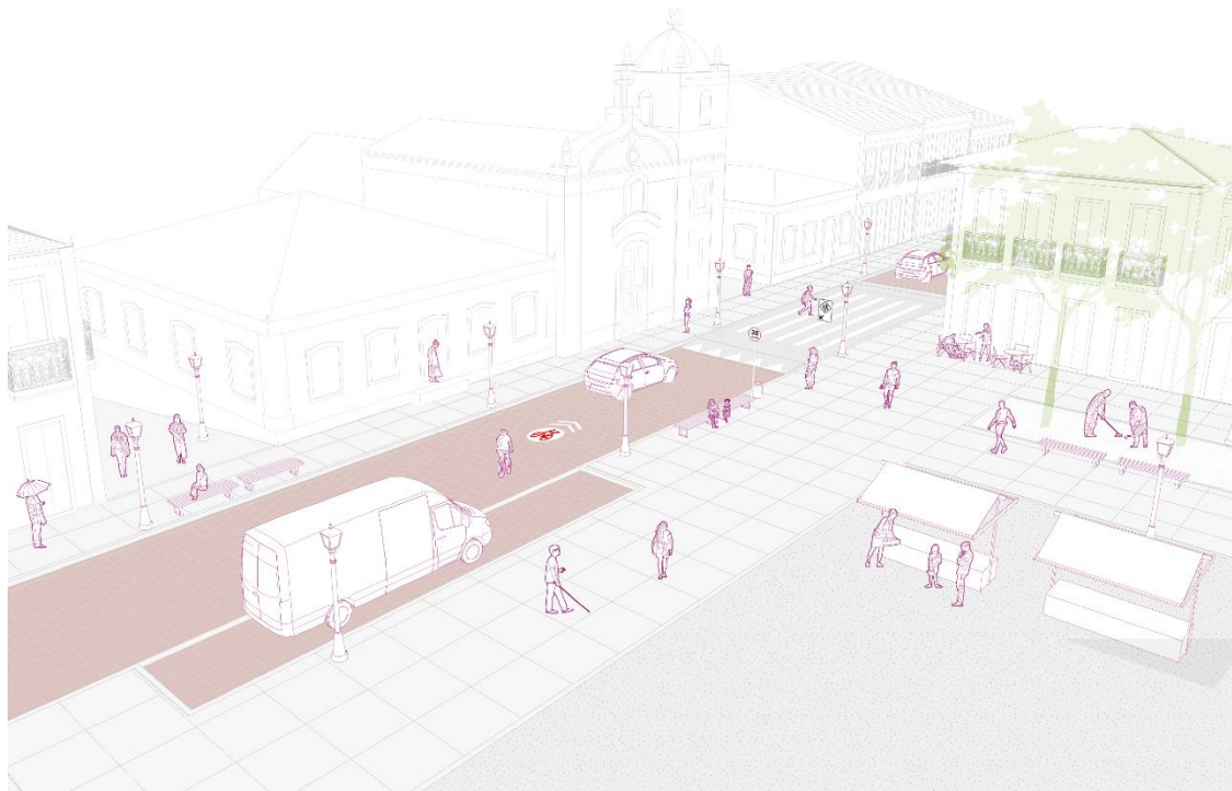
Figura 37 - Texturização e pavimento colorido implantados em conjunto com platô, em via local unidirecional com ciclorrota, localizada em área central com existência de polos geradores de tráfego.
