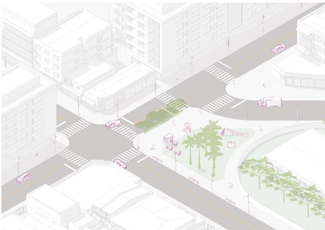
Figura 16 - DEPOIS: Extensão de meio-fio implantada para melhor ajustes de alinhamento em interseção.
