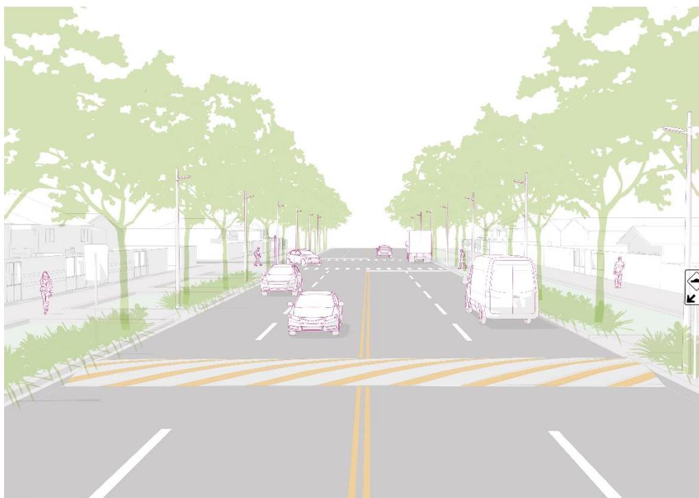
Figura 48 - Estreitamento visual criado a partir da implantação de elementos verticais em via arterial bidirecional.
