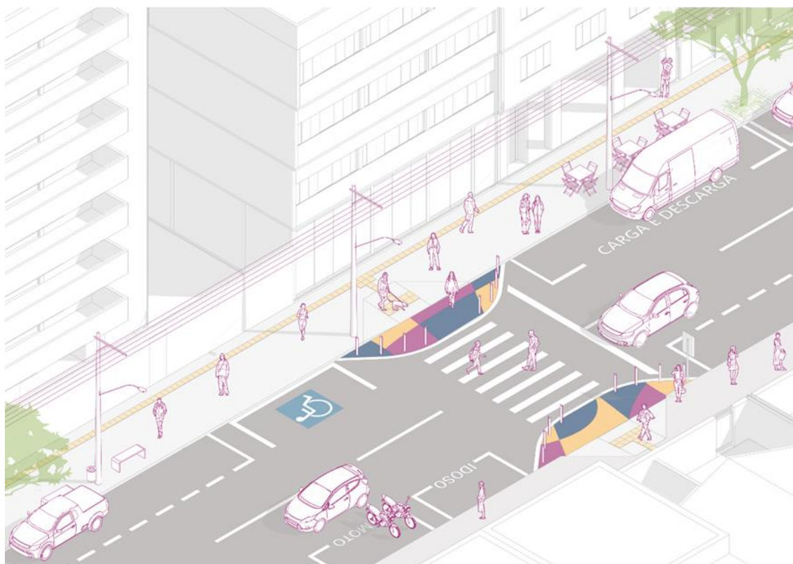
Figura 33 - Estacionamento implantado em ambos os lados da via em conjunto com extensões de meio-fio em via coletora unidirecional.
