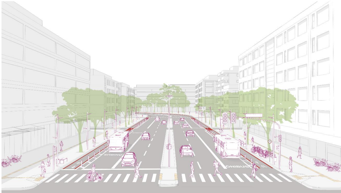
Figura 29 - Largura das faixas de tráfego vista em seção transversal de via arterial bidirecional com canteiro central, ciclovias unidirecionais em ambos os lados e faixa exclusiva para transporte coletivo.
