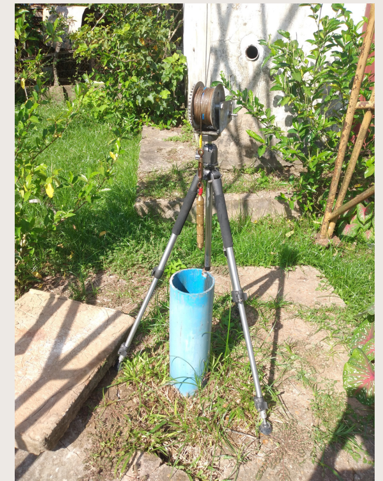
Perfilagem geotérmica em poço de água subterrânea - Humaitá - AM - Brasil
