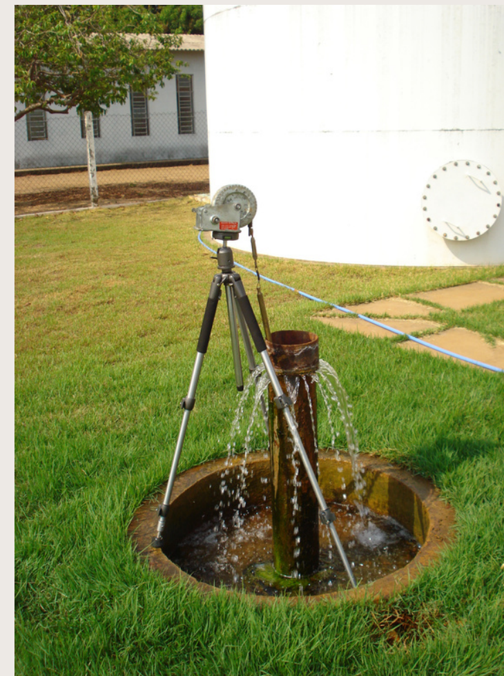
Perfilagem geotérmica em poço de água subterrânea jorrante - Palmeirante - TO - Brasil
