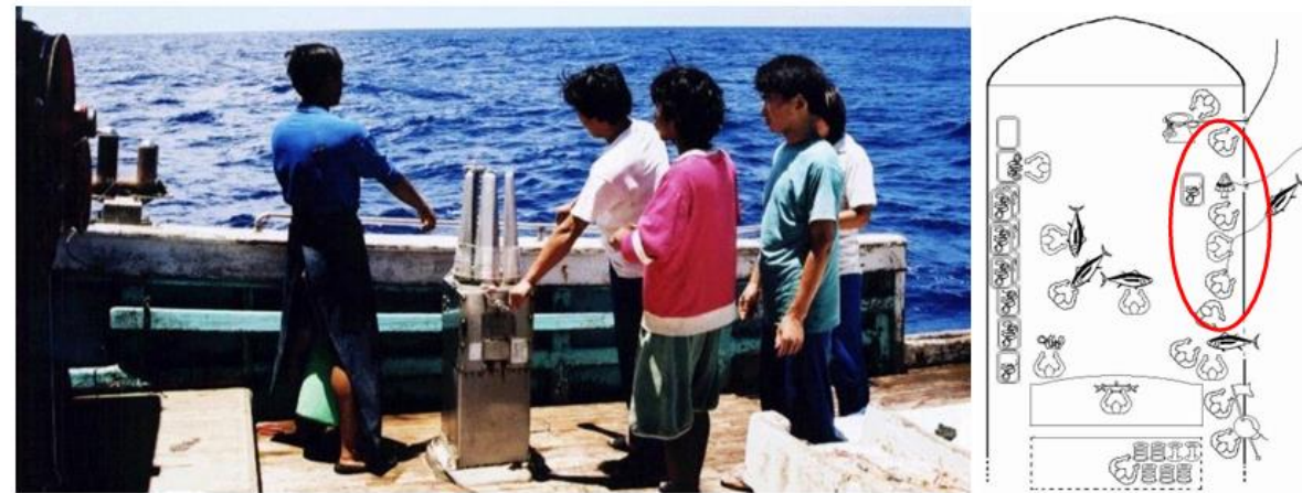
Figura 50: Tripulante operando o guincho de "enrolar e içar" linhas secundárias durante operação de recolhimento a bordo de espinheleiro arrendado de China-Taipei. Ao lado esquema da proa indicando o local e os tripulantes fotografados. Foto adaptada de Tavares (2002).
