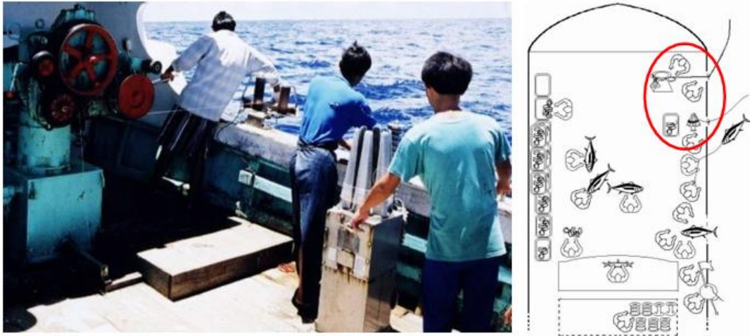
Figura 49: Tripulantes operando o guincho da linha principal e o guincho das linhas secundárias durante operação de recolhimento a bordo de espinheleiro arrendado de China-Taipei. Ao lado esquema da proa indicando o local e os tripulantes fotografados. Foto adaptada de Tavares (2002).
