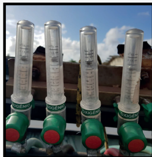
Foto 3 - Fluxômetro de oxigênio em caminhão transportador de tilapias;
