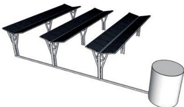
Figura 6 - Projeto conceitual de um sistema de captação da água da chuva com cisterna de armazenamento
