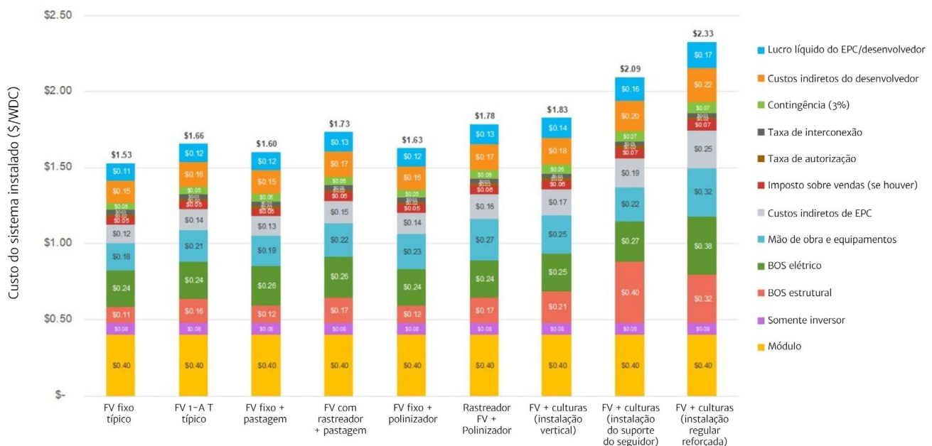
Figura 62 – Custos típicos de instalação de sistemas FV comparados aos custos de diferentes configurações de sistemas agrivoltaicos
