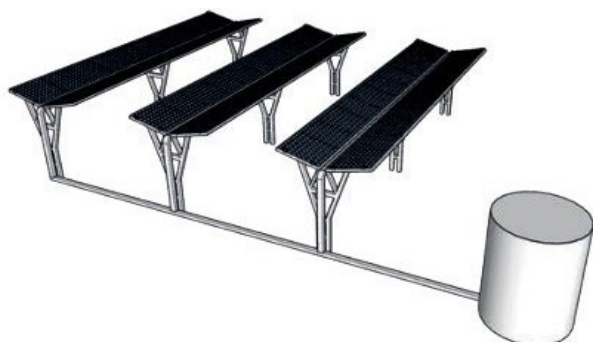
Figura 6 - Projeto conceitual de um sistema de captação da água da chuva com tanque de armazenamento
