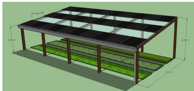
Figura 56 - Casa de vegetação agrivoltaica
