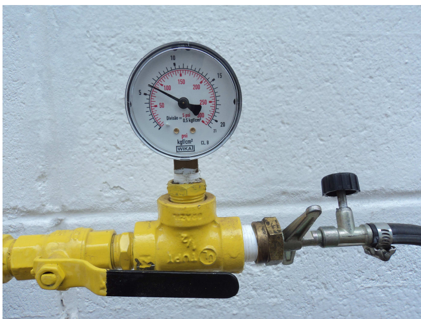
FOTO 20 – DETALHE DO MANÔMETRO DE PRESSÃO DO RECIPIENTE COM REGULAGEM VÁLVULA AGULHA NA SAÍDA DE ALTA PRESSÃO DO GÁS LP
