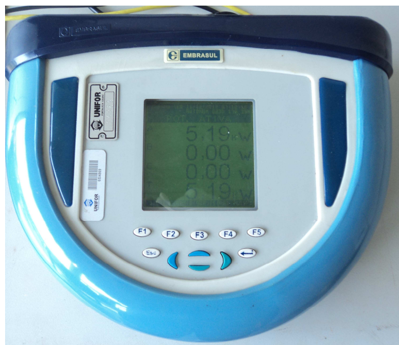
FOTO 09 – ANALISADOR DE ENERGIA – UTILIZADO NA MEDIÇÃO DO CONSUMO DO GERADOR
