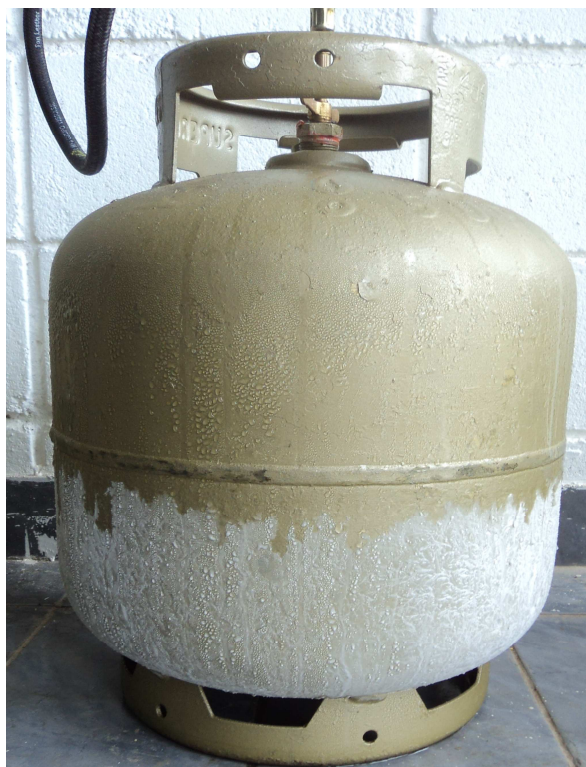
FOTO 10 – DETALHE DA CAMADA DE GELO NO RECIPIENTE
