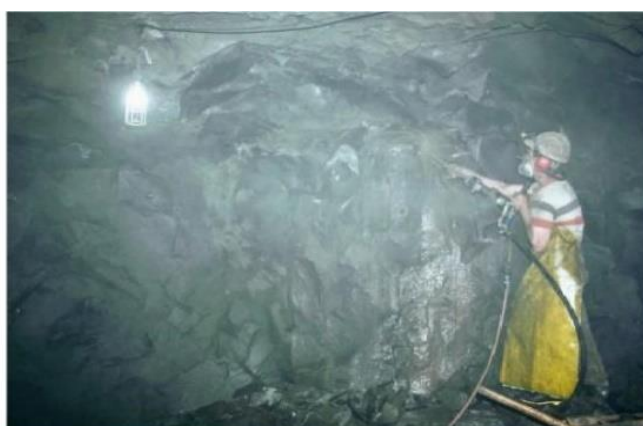
Fig. 2 Registro de Garimpeiro realizando a Perfuração a úmido, com os EPIs.
