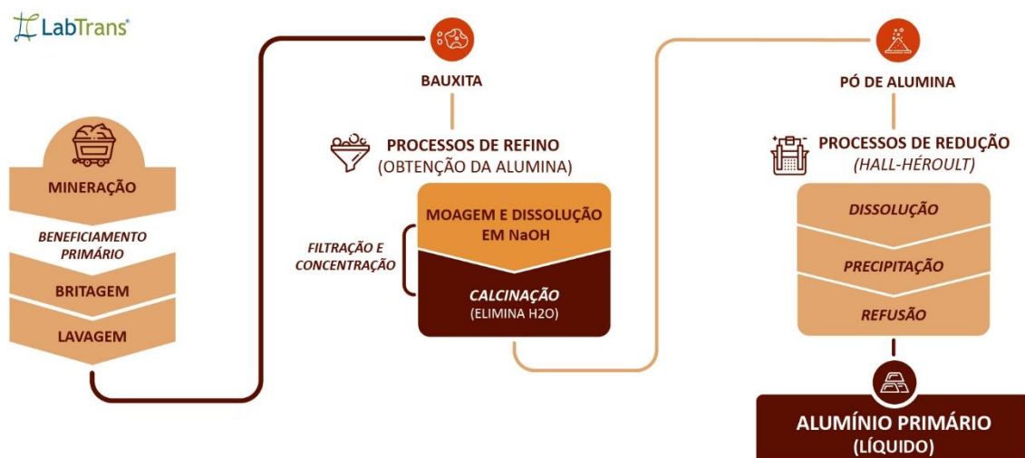
Figura 10 – Fluxograma do processo produtivo do alumínio primário
