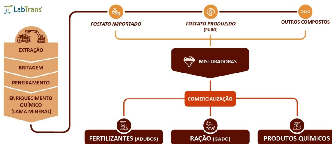
Figura 20 – Fluxograma do processo produtivo do cloreto de fosfato
