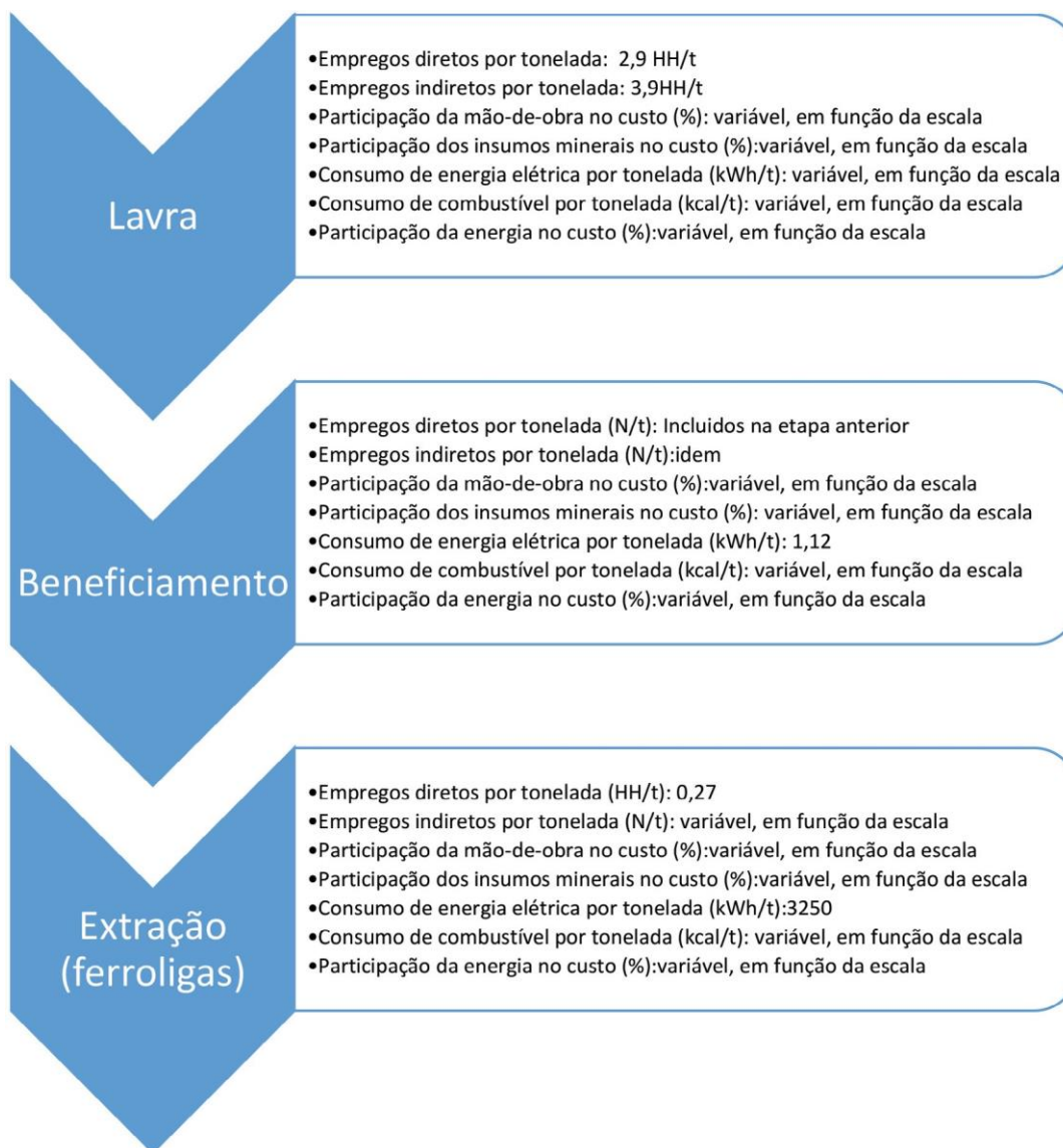
Figura 10. Fluxograma simplificado da cadeia do manganês.
