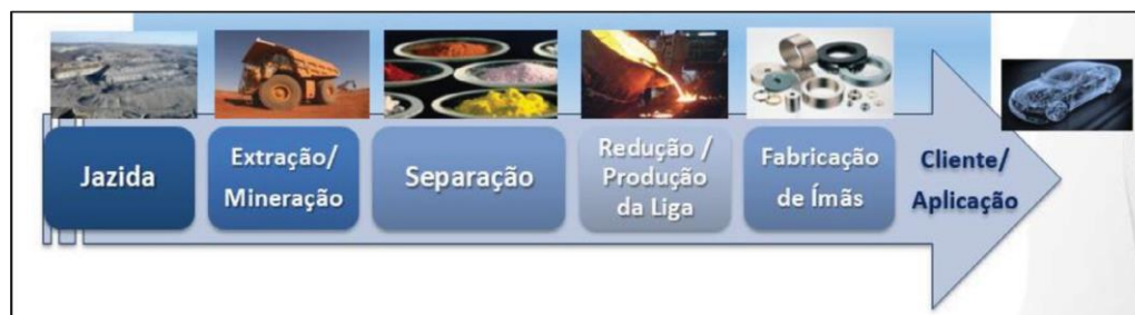
Figura 9. Fluxograma geral do processo de fabricação de ímãs.
