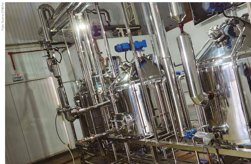
Equipamentos para a realização do processo de mostura, clarificação e fervura, em indústria participante do projeto
