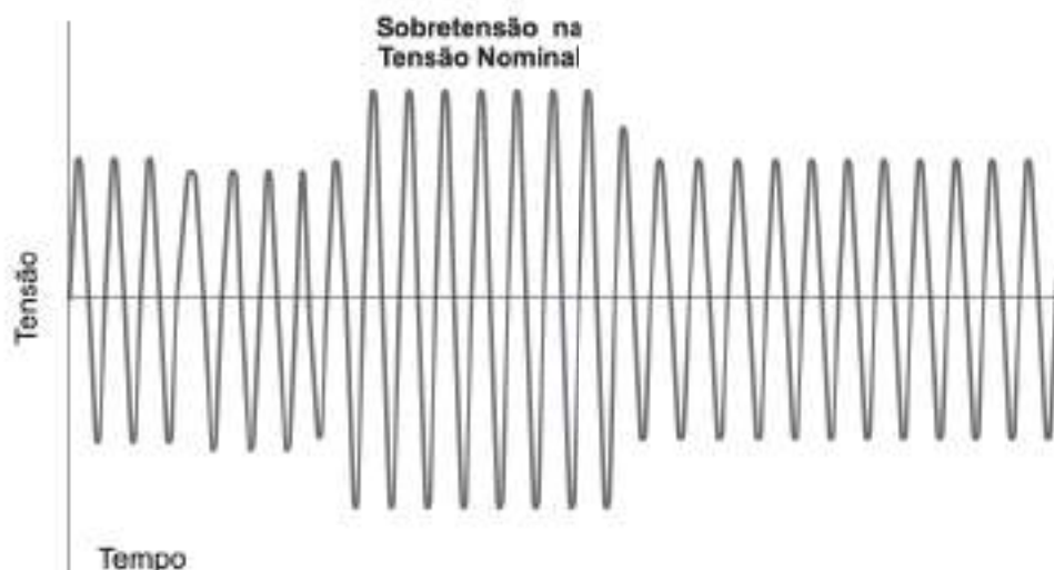
Figura 3.19 - Gráfico com ocorrência de sobretensão.
