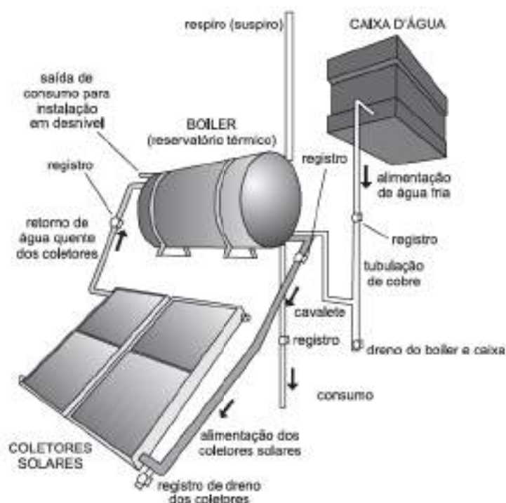
Figura 4.22 – Componentes de instalação solar.
