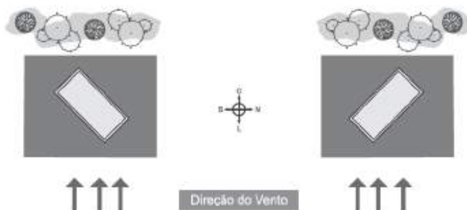
Figura 1.8 – Exemplo de implantação da edificação, com inclinação de no máximo a 45° da direção principal do vento.
