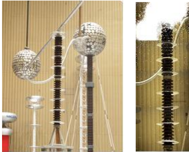
Figura 7 – Fabricante A – Disposição dos BS e Quadro da filmagem com câmera UV. Ensaio de tensão suportável a 60 Hz, 885 kV, sob chuva de 5 mm/min por 3 minutos.
