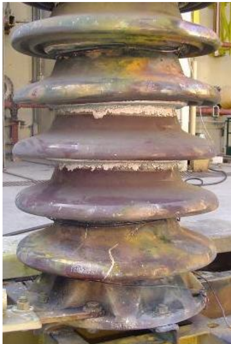
Figura 3 – Coluna de isolador no ensaio de arco de potência - Detalhe da trinca
