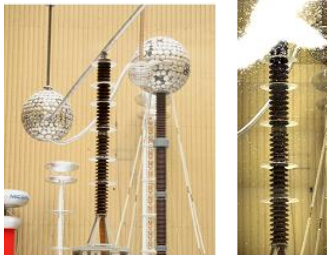
Figura 8 – Fabricante B – Disposição dos BS e Quadro da filmagem com câmera UV. Ensaio de tensão suportável a 60 Hz, 885 kV, sob chuva de 5 mm/min por 3 minutos.
