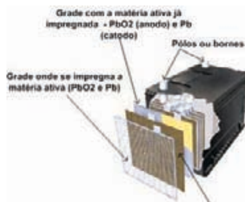
Figura 5.4 – Constituição interna de uma bateria de Pb-ácido
