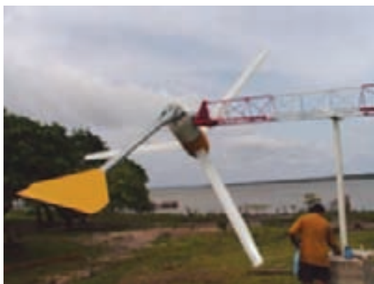
Aerogerador acoplado à torre
