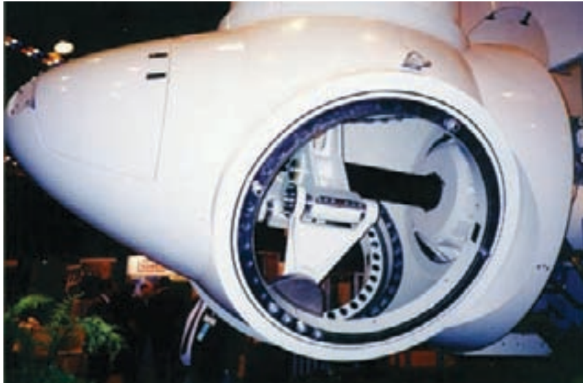
Figura 3.30 – Cubo de um aerogerador de grande porte
