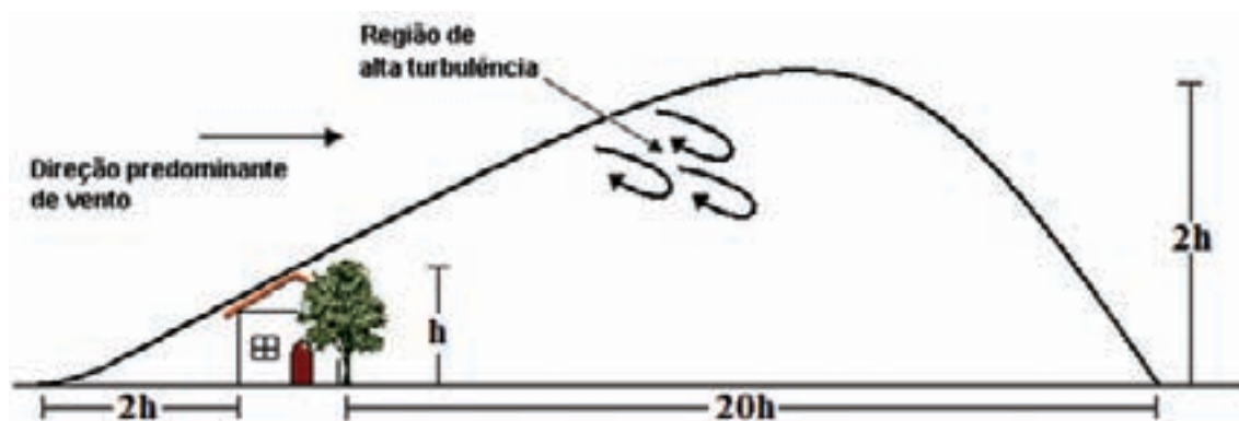
Figura 3.13 – Região de turbulência originada por um obstáculo de altura h
