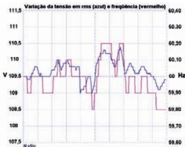
Figura 13.24 – Variação rms de tensão e variação da frequência – Tamaruteua (diesel operando)
