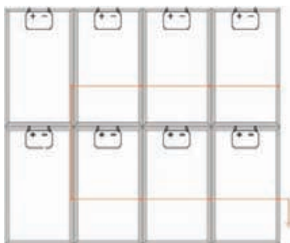
Figura 9.9 – Aterramento de módulos fotovoltaicos
