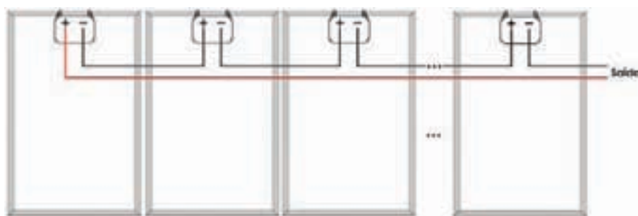
Figura 2.41 – Associação de n módulos em série
