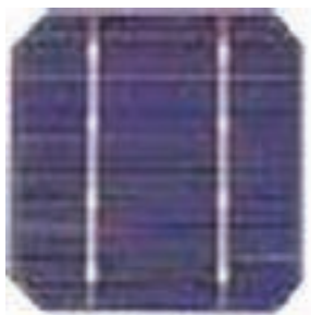
(a) - Célula de silício monocristalino
