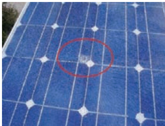
Figura 10.2 – Módulo com o vidro quebrado
