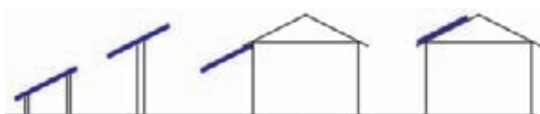
Figura 9.3 – Algumas formas de instalação de módulos fotovoltaicos
