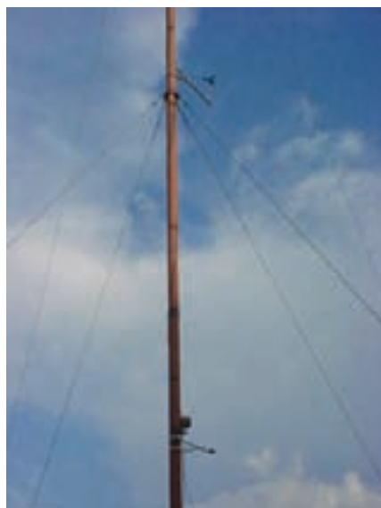
Figura 3.12 – Torre tubular estaiada para medição de potencial eólico
