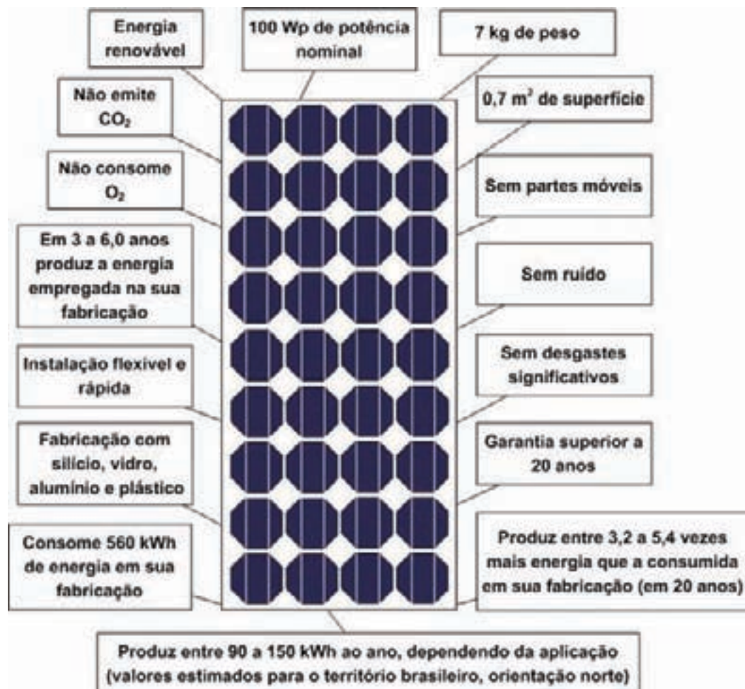
Figura 2.54 – Características dos módulos fotovoltaicos
