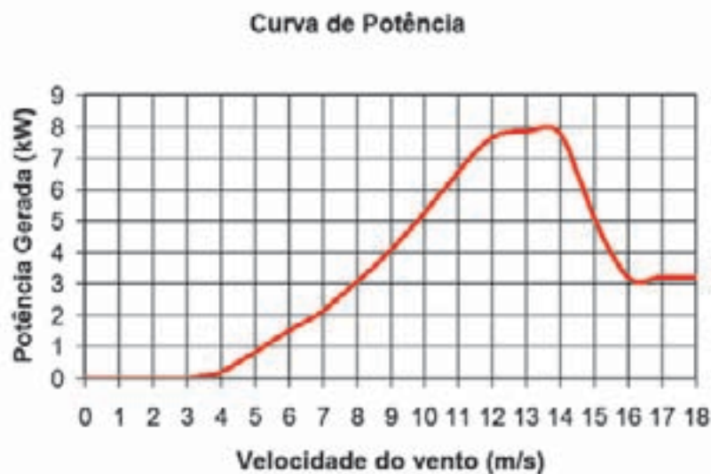
Figura 8.9 – Curva de potência de um aerogerador
