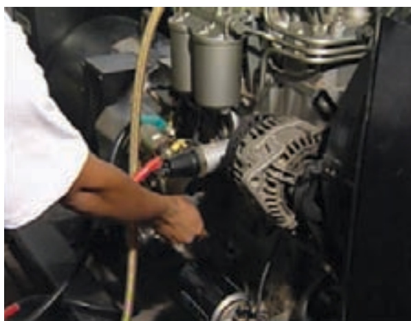
Figura 10.5 – Verificação do nível do óleo lubrificante
