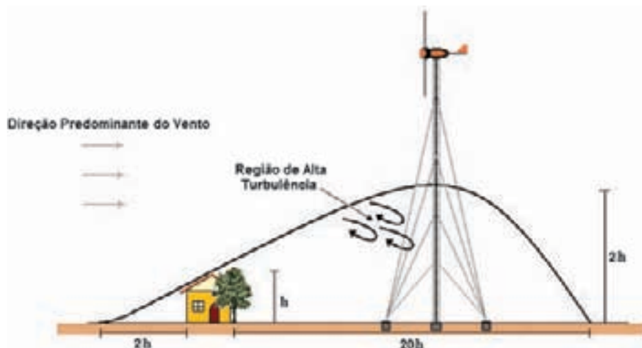
Figura 9.16 – Técnica de instalação de aerogerador
