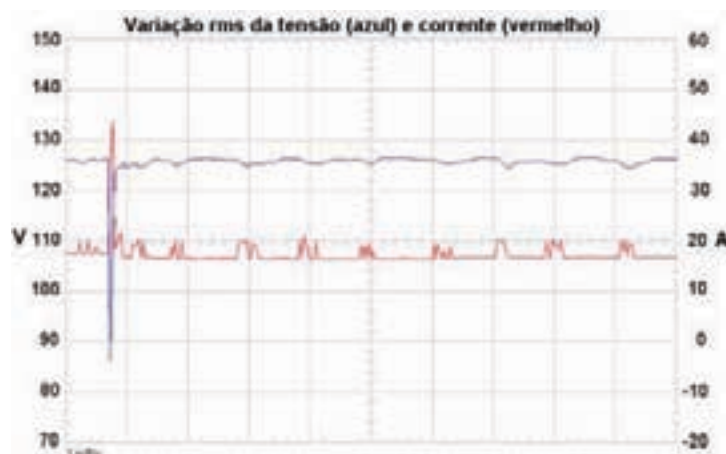
Figura 13.21 – Variação do valor rms de tensão e corrente da fase C (São Tomé)
