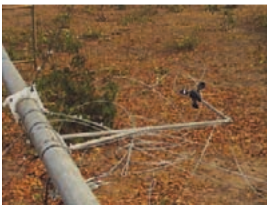
Anemômetro fixado na torre por meio de um suporte extensor
