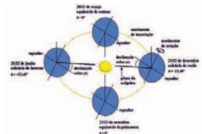
Figura 2.6 – Órbita da Terra em torno do Sol: posição da terra com relação ao Sol nos solstícios e equinócios
