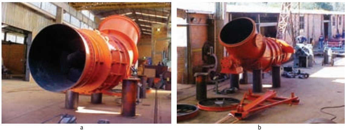
Figura 2.9 – Turbina Kaplan “S” com acoplamento do gerador: (a) e (b) Turbina “S” fabricação Haker – SC, Brasil.
