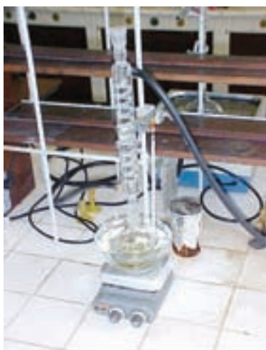
Figura 4.10 – Aparelhagem de refluxo usada nas reações homogêneas
