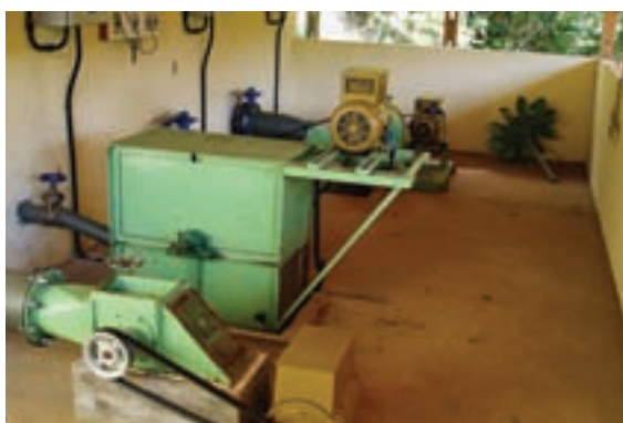
Figura 2.12 – Roda Pelton: (a) Grupo gerador com roda Pelton, fabricação Alterima (no primeiro plano vê-se um grupo gerador com turbina Michell-Banki – Unifei); (b) roda Pelton.
