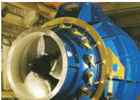
Figura 2.10 – Turbina Bulbo: (a) com rotor de pás móveis, gerador interno, a montante, sendo inspecionada na fábrica; (b) tipo tubular com acoplamento do gerador a jusante, em operação.
