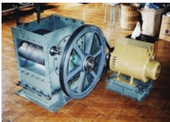
Figura 2.11 – Turbinas Hidráulicas desenvolvidas pela Unifei: (a) Michell-Banki e (b) Bomba Funcionando como Turbina – BFT
