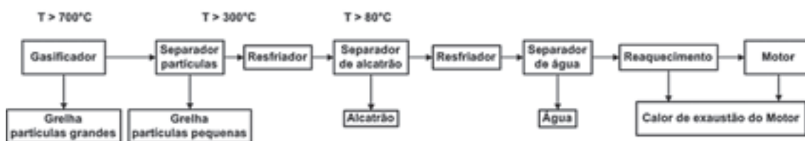
Figura 3.3 – Relação esquemática de temperatura do gás para remoção de contaminante
