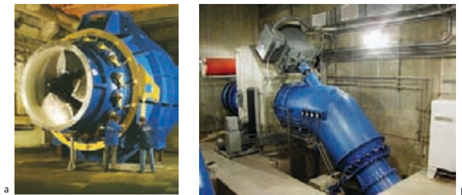
Figura 2.23 – Turbina bulbo: (a) com rotor de pás móveis, gerador interno, à montante, sendo inspecionada na fábrica; (b) tipo tubular com acoplamento do gerador à jusante, em operação
