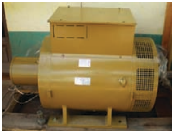
Figura 9.35 – Gerador a ser utilizado na central
