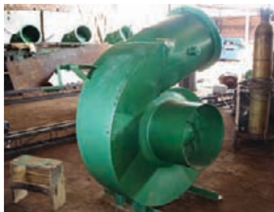
Figura 9.36 – Turbina a ser utilizada na central (ainda na oficina do fabricante)
