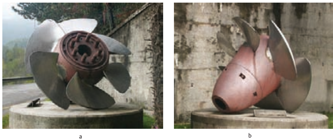
Figura 2.21 – Rotor de turbina Kaplan com seis pás: (a) vista frontal; (b) vista lateral
