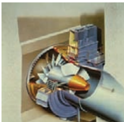
Figura 2.24 – Principais componentes de uma turbina straflo
