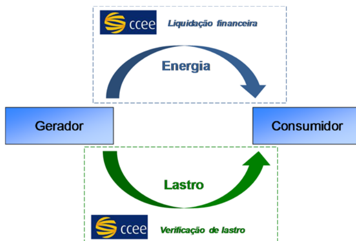
Figura 5-2 – Contabilização de lastro e energia na CCEE
