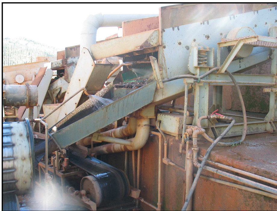
Figura 10.10 – Entrada no sistema de tromel do minério deslamado - Mina Belmont.
