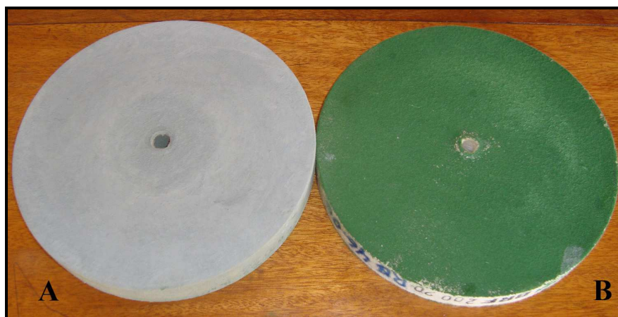
Figura 11.20 – Discos de feltro utilizados na lapidação de cabochões: A – disco com pó de esmeril, para acabamento fino; B – disco com óxido de cromo para polimento. Fotografias: Silva Filho, A. F. 2009.
