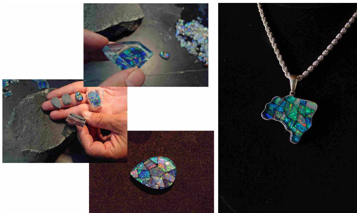
Figura 19.1 -As etapas de aproveitamento artesanal da opala de Pedro II. Fragmentos de opala sem nenhum jogo de cores, após colada numa rocha preta e recoberta por vidro comum passa a se constituir numa peça de alto valor.
