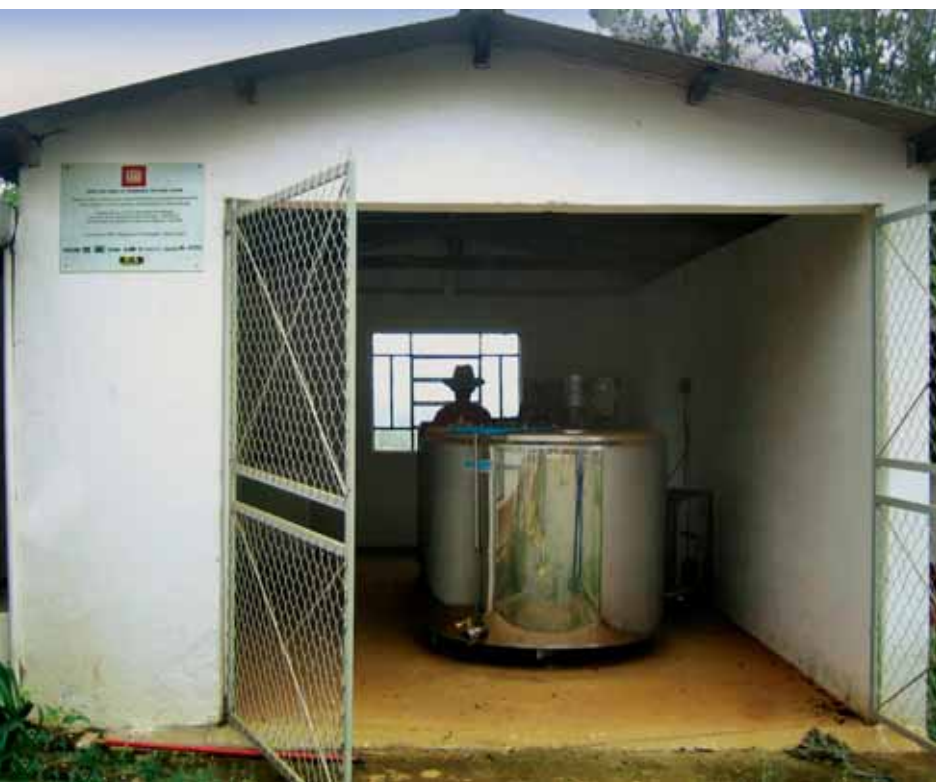
Tanque de expansión para el almacenamiento de leche – municipio de Carvalhópolis – Minas Gerais
