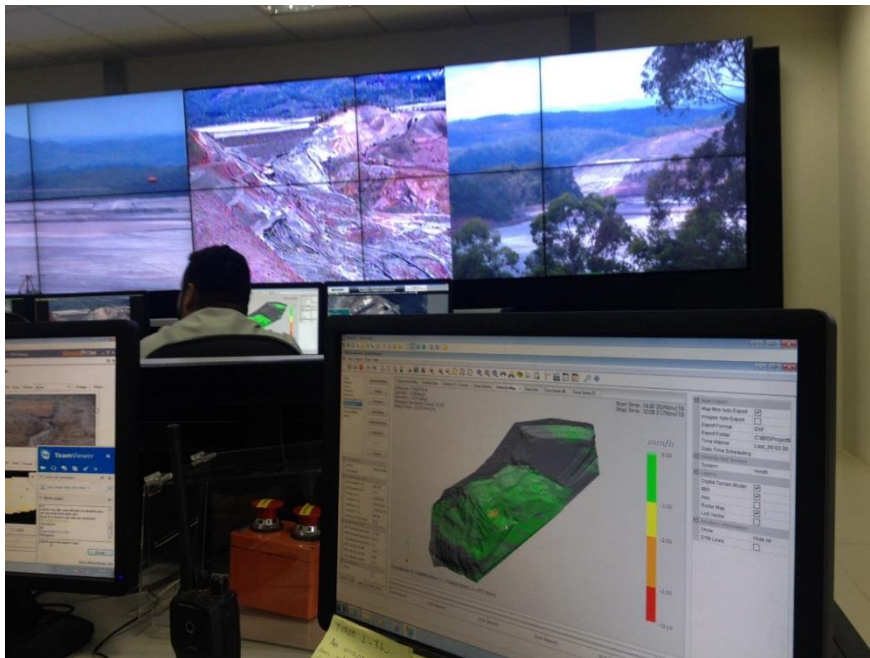
Figuras 6 e 7 - Sistema de acionamento do alarme para as barragens e comunidades a jusante
