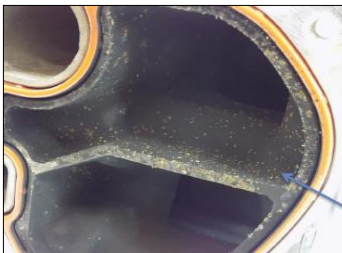
Figura 9: Condutos internos da Válvula EGR.
