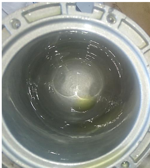
Figura 4 : Aspecto do corpo do elemento filtrante do filtro de combustível após o teste.
