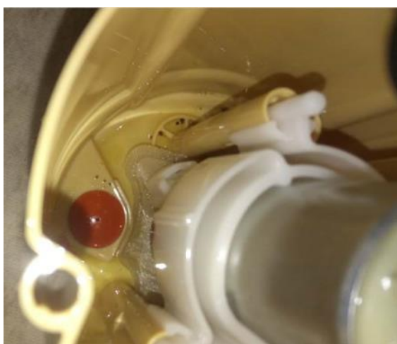
Figura 2 : Aspecto do copo da bomba de combustível elétrica “in tank” após o teste.
