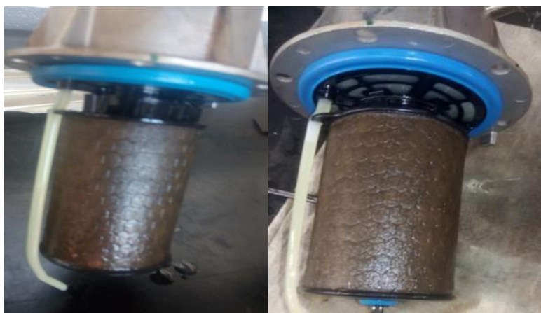
Figura 3 : Aspecto do elemento filtrante do filtro de combustível antes e depois do teste.
