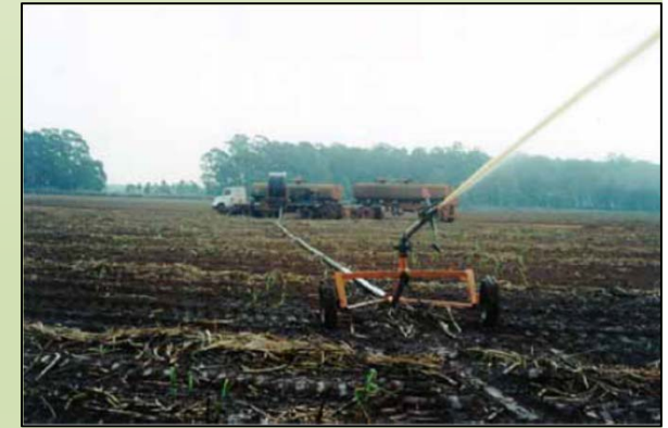
Carretel enrolador (ou rolão) acoplado no caminhão
