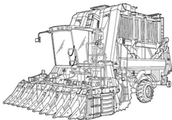
Colhedora de café: equipamento agrícola automotriz que efetua a "derriça" e a colheita de café.
