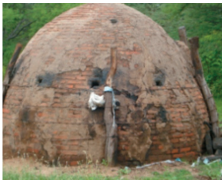
Figura 2.26: Forno de Alvenaria utilizado na produção de carvão no município de Lajes - RN.
