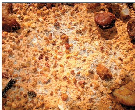
Figura 2.3: Salinização do solo proveniente dos rejeitos de dessorizador na comunidade de Barra da Espingarda
