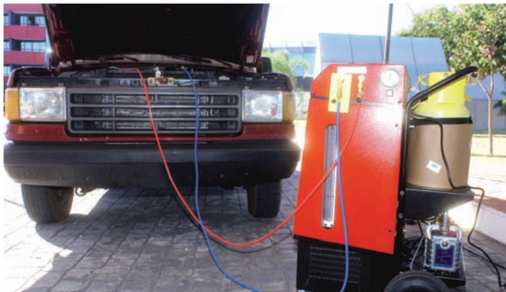
Oficinas de automóveis foram preparadas para recolhimento de CFC em aparelhos de ar condicionado. Equipamentos foram financiados pelo Fundo Multilateral para Implementação do Protocolo de Montreal
