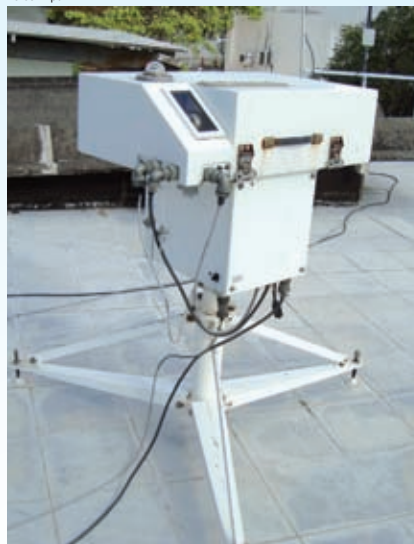
Instrumentos de solo para monitoramento da camada de ozônio. À esquerda Espectrofotômetro Brewer; acima Espectrofotômetro Dobson
