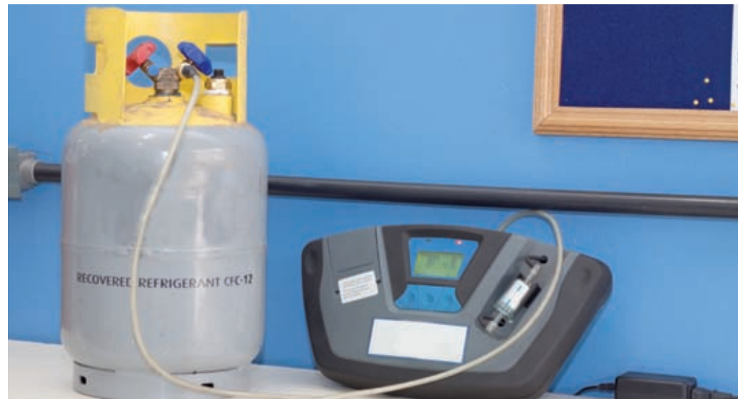
Conjunto para identificação de substâncias que destroem a camada de ozônio usado pela Receita Federal e pelo Ibama em fronteiras, portos e aeroportos para impedir o comércio ilícito
