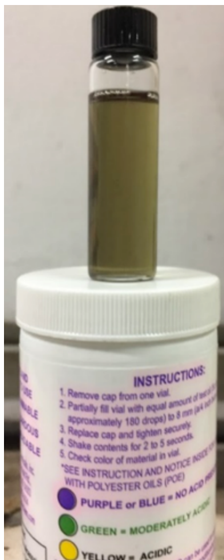
Figura 58 – Teste de óleo (a cor verde indica acidez moderada)
