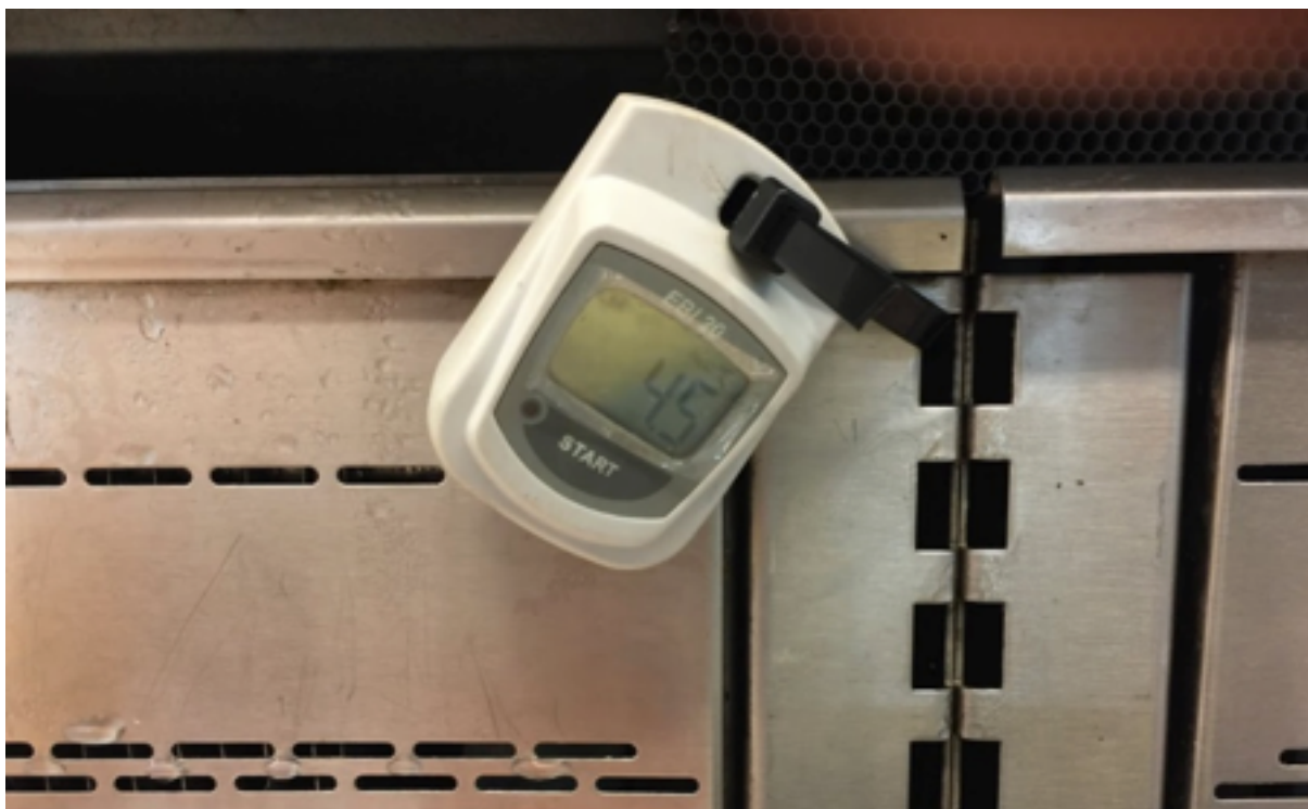
Figura 13 – Datalogger instalado em expositor de carnes
