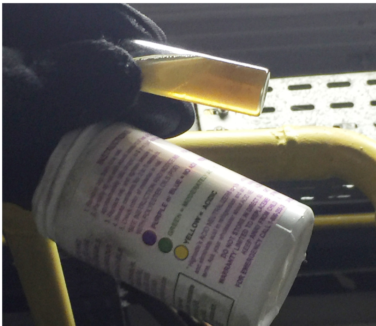
Figura 23 – Amostra de óleo apontando acidez nos sistemas (a cor amarela indica acidez)
