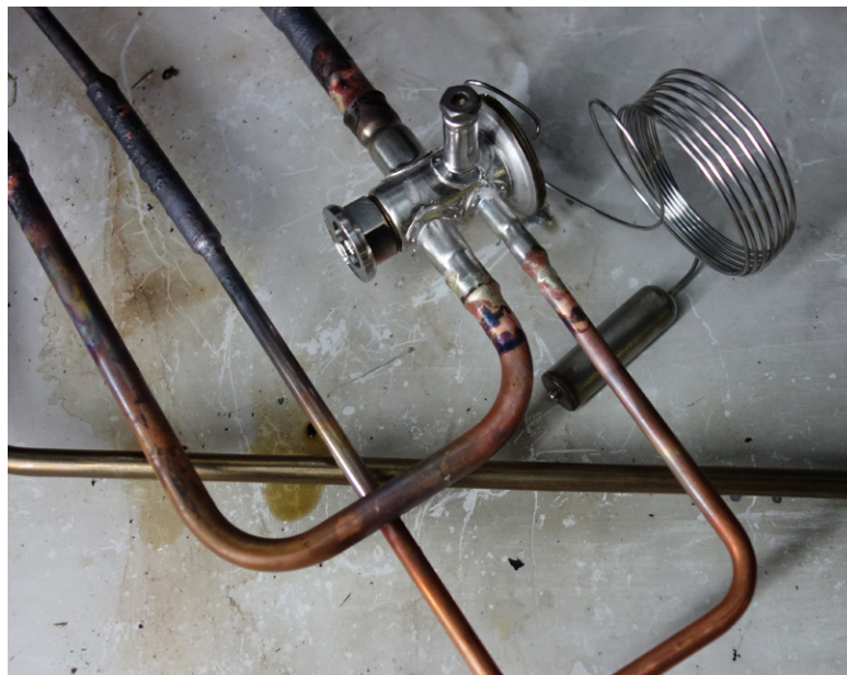
Figura 30 – Válvula de expansão com conexões brasadas ( Danfoss , modelo TUA )
