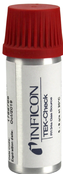
Figura 6 – Exemplo de vazamento de referência
