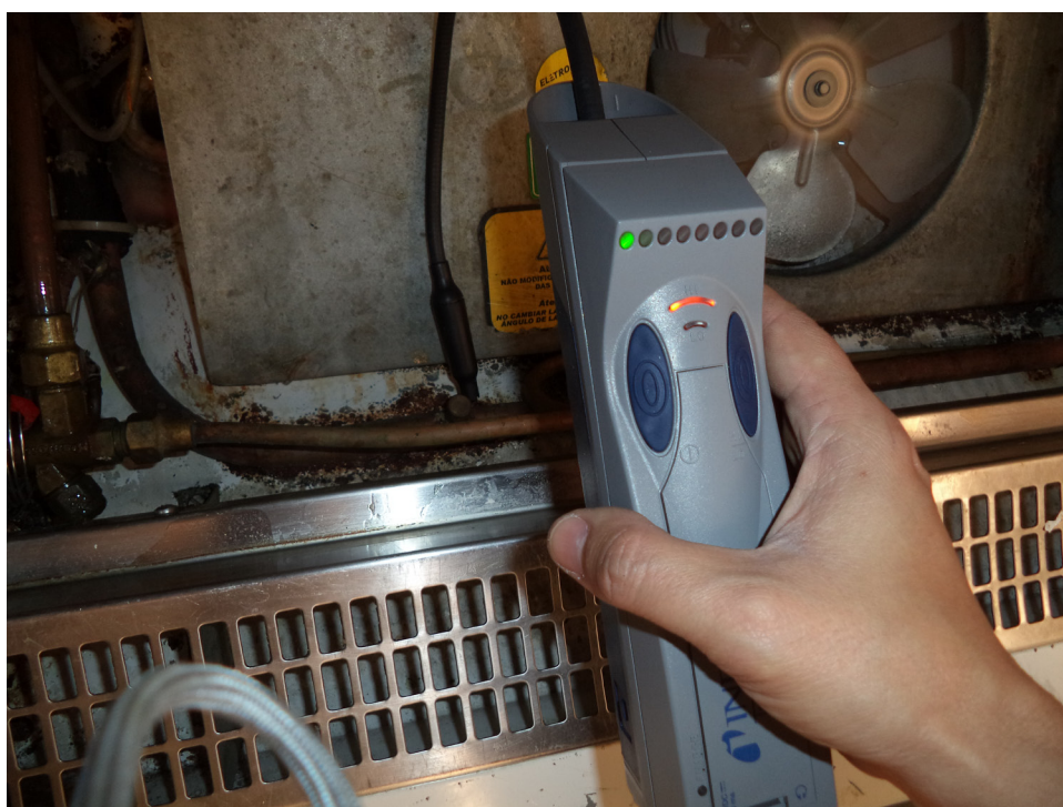
Figura 24 – Detector eletrônico de gases halogenados para identificação de microvazamentos
