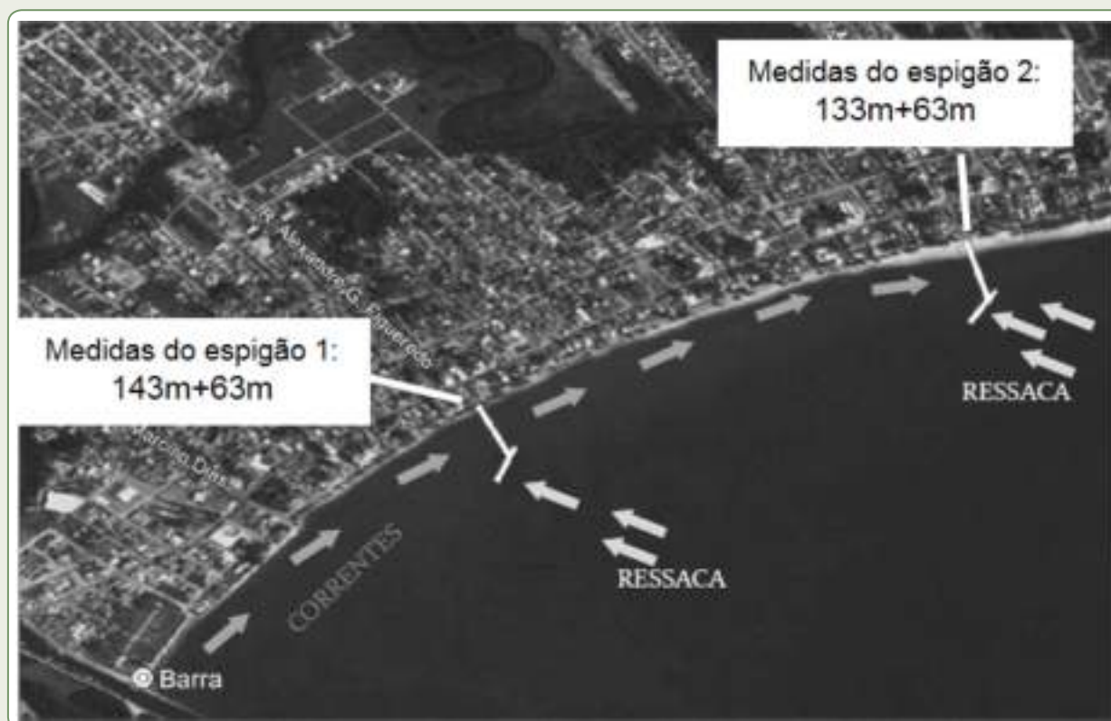
Figura 13.2 – Apresentação do projeto de recomposição da Praia de Piçarras, executado entre 2012/2013, com construção de dois espigões em forma de T e engorda de praia
