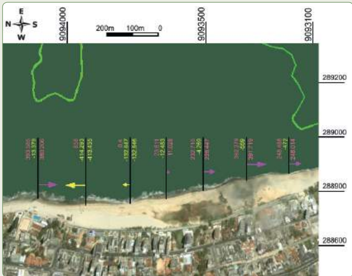
Figura 7.15 – Transporte líquido anual de sedimentos em perfis de praia selecionados ao longo da área de estudo para a configuração sem quebra-mar
