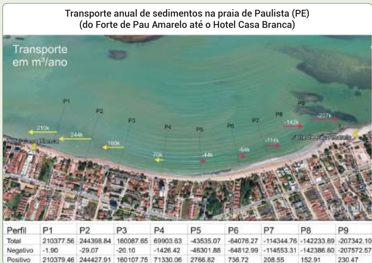
Figura 6.24 – Cálculo do transporte médio anual de sedimentos nos perfis de praia selecionados
