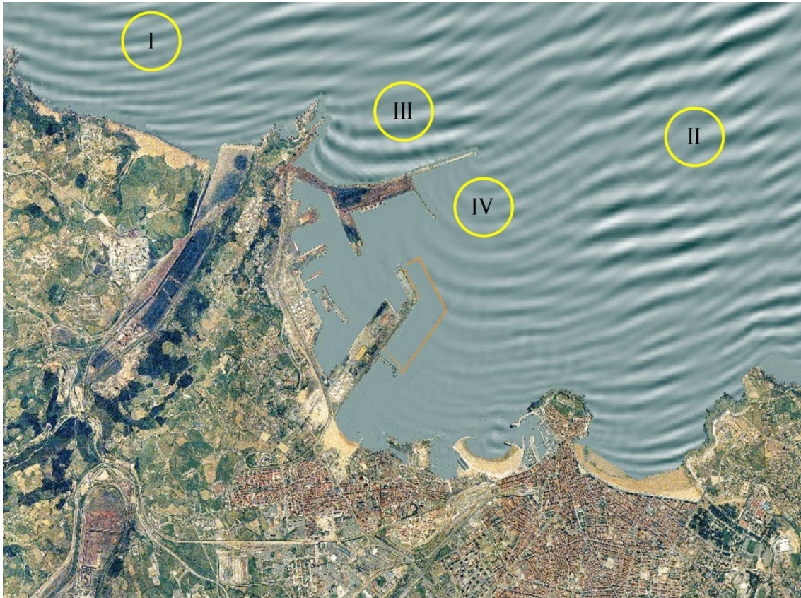
Figura 3: I Refração; II Empinamento; III Reflexão e IV Difração.
