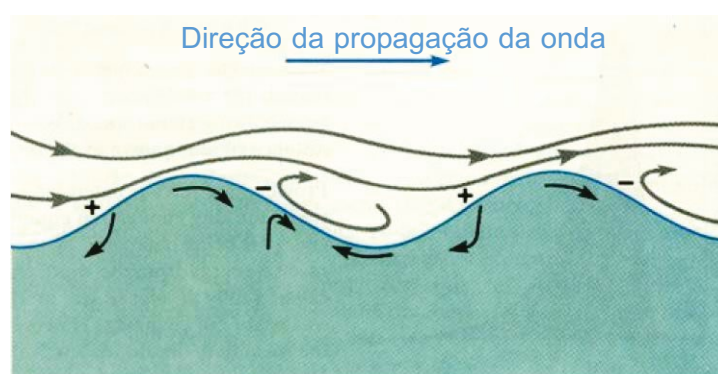
Figura 2: Modelo de Jeffrey de geração de ondas. Este diagrama mostra o processo de geração das ondas de vento, apresentando como o fluxo de ar causa diferenças de pressão diferenciais que acentuam as ondas. Áreas positivas e negativas da pressão são mostradas mediante os símbolos de mais e menos. As setas curvadas representam os fluxos de ar e água.
