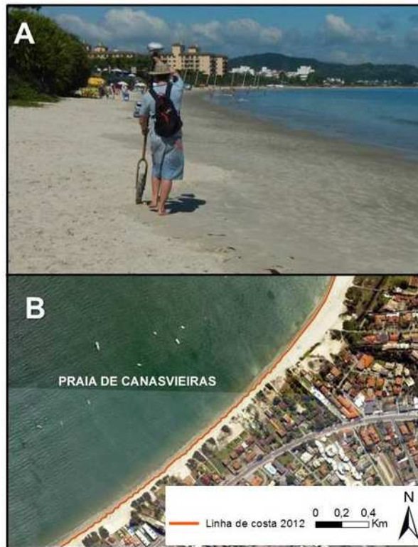
Figura 7 – (A) Levantamento da linha de costa em campo com uso de um GPS/RTK adaptado a uma roda de bicicleta sobre o indicador areia seca/molhada. Fotografia Mariela Muler. (B) Representação da linha de costa coletada em campo. Fotografia de fundo SDS, 2010. Fonte: Klein et al. (2016).
