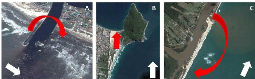
Figura 14 – Tipos de transposição de sedimentos. Em (A) é representado o processo de bypassing em Torres/RS de forma a transportar os sedimentos retidos no molhe que fixa a desembocadura do rio Mampituba para a sotamar; em (B) o processo de overpassing na Ilha de Santa Catarina (Florianópolis/SC) da praia do Santinho para a praia dos Ingleses e; em (C) o processo de backpassing na praia de Barra Velha/SC de forma a devolver o sedimento acumulado no esporão arenoso para a praia a barlar. As setas vermelhas indicam o sentido da transposição de sedimento, já as setas brancas indicam o sentido normal do transporte de sedimentos na zona costeira. Fonte: imagens: Google Earth.
