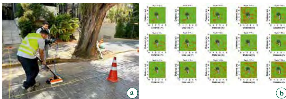
Figura 6.10 – Radar: a) Uso do radar na avaliação do sistema radicular; b) um exemplo de radargrama, indicando a presença das raízes.
