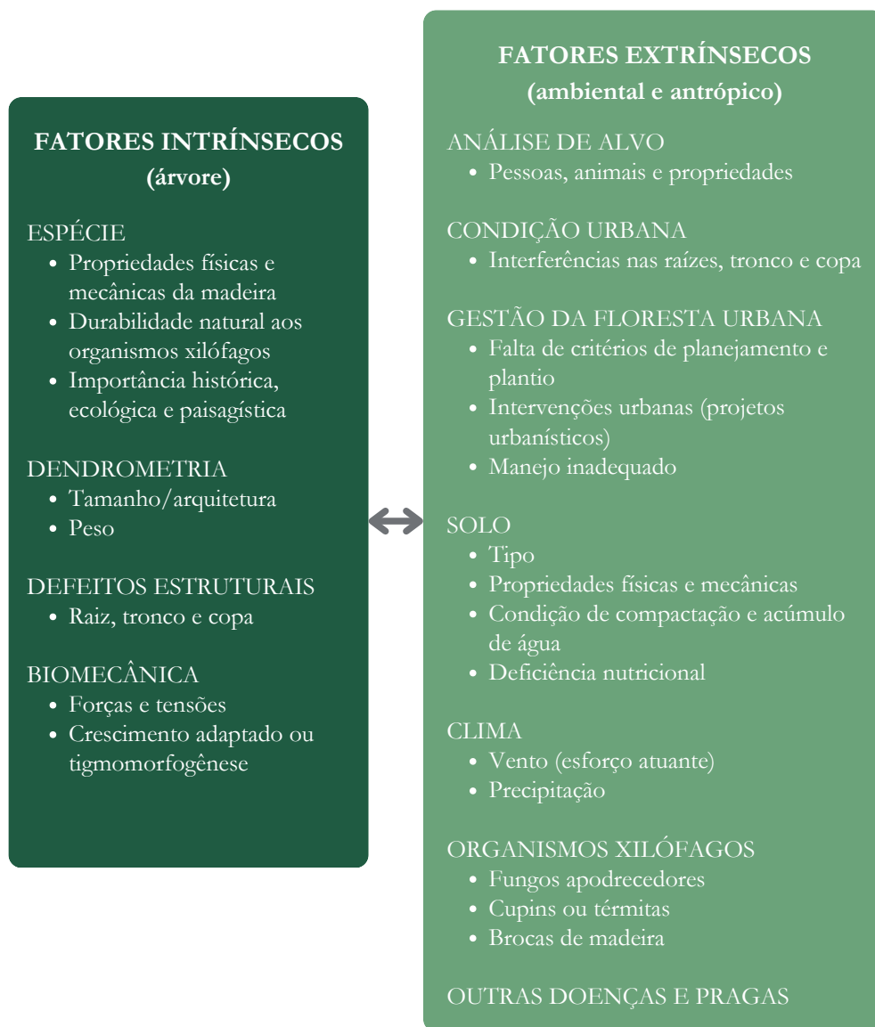
Figura 7.1 – Interação de fatores na análise de risco de queda de árvores.
