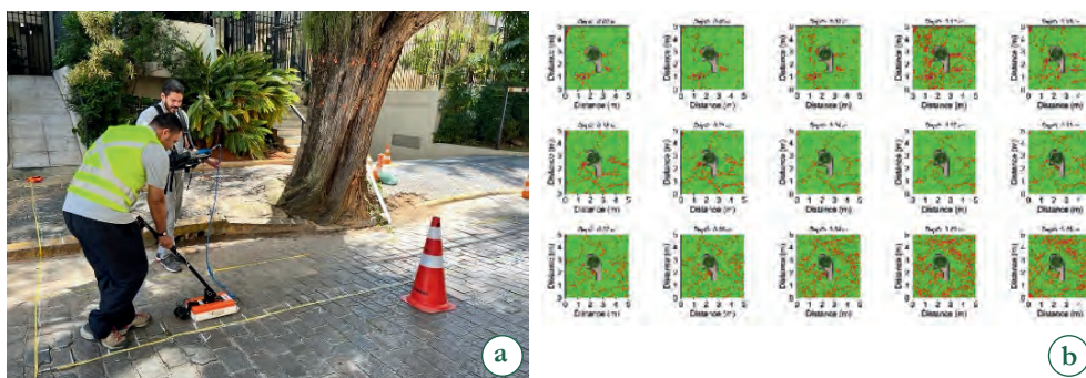
Figura 6.10 – Radar: a) Uso do radar na avaliação do sistema radicular;
