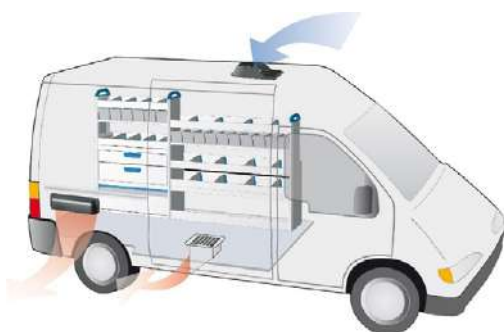
Figura 191 – Sistema de entrada de ar
