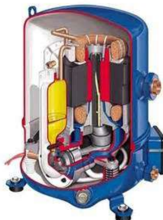
Figura 230 – Vista em corte de compressor de pistão alternativo hermético (RAC comercial)
