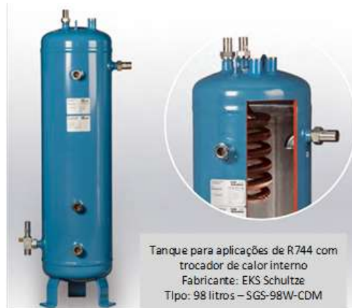
Figura 304 – Tanque de líquido para aplicação com R-744 PS 60 bar com trocador de calor interno para operação de sistema de refrigeração interno
