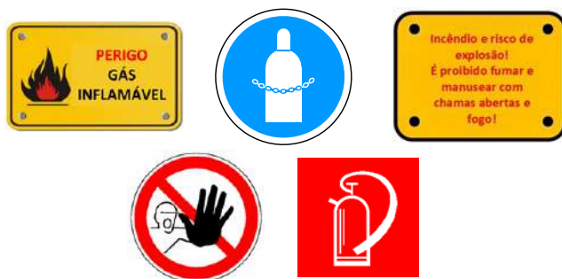
Figura 182 – Exemplo de marcações apropriadas para depósitos externos
