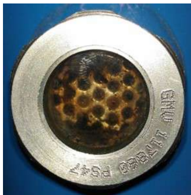
Figura 273 – Compressor com sistema de lubrificação altamente contaminado
