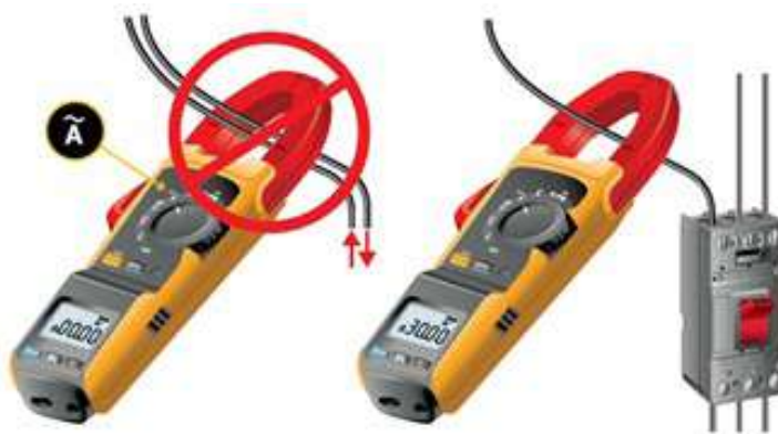
Figura 429 – Usando um alicate amperímetro para medir corrente
