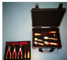
Figura 111 – Exemplo de conjunto de ferramentas de serviço antifaíscas para o circuito de refrigeração inflamável
