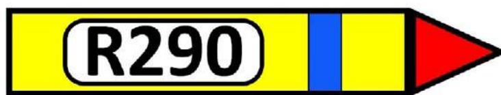
Figura 374 – Exemplo de etiqueta de identificação de tubos carregando fluido refrigerante inflamável de acordo com a DIN 2405. Gás de sucção (azul), fluido refrigerante R-290, inflamável = seta vermelha
