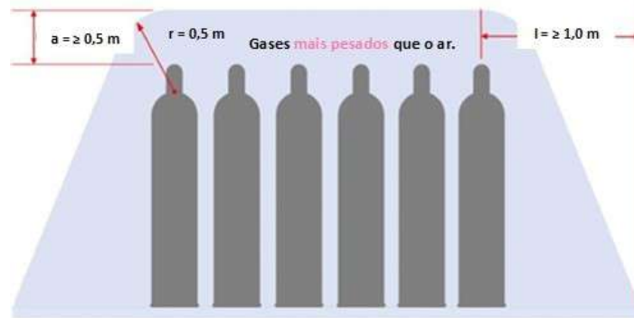
Figura 184 – Área protegida externa para gases mais pesados que o ar
