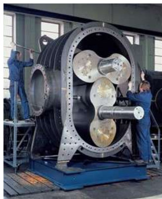
Figura 228 – Compressor de lóbulos para processo industrial
