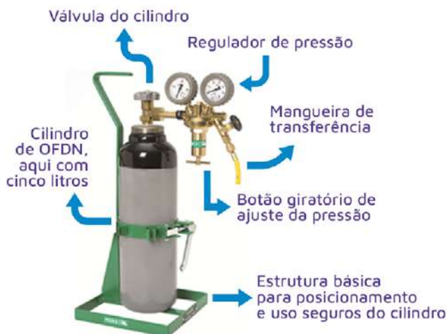
Figura 89 – Exemplo de organização do cilindro OFDN com regulador de pressão
