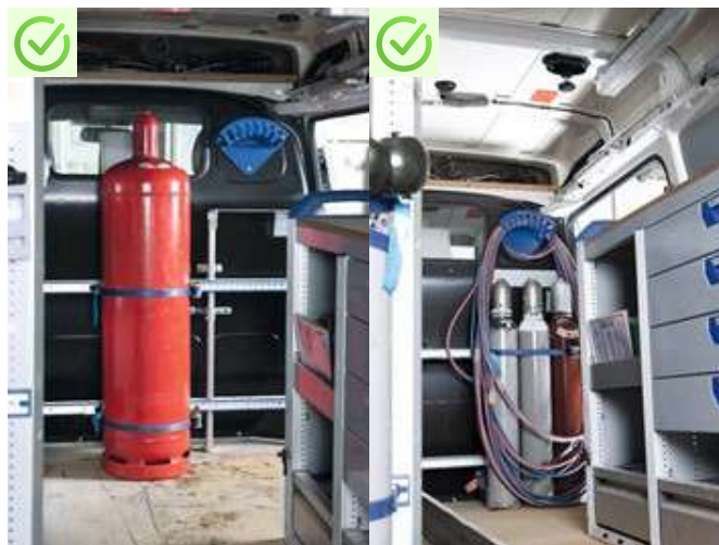
Figura 189 – Segurança de carga ideal para cilindro de gás pressurizado (esquerda) e cilindro de propano seguro em pé (direita)
