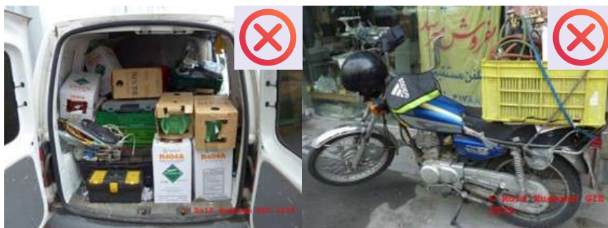
Figura 186 – Distribuição de carga inadequada e perigosa em carro de serviço (esquerda) e transporte inadequado de cilindros de gás comprimido em motocicleta (direita)
