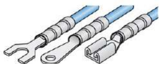
Figura 448 – Crimpagem de terminais de cabos para usar em conexões de fios flexíveis.
