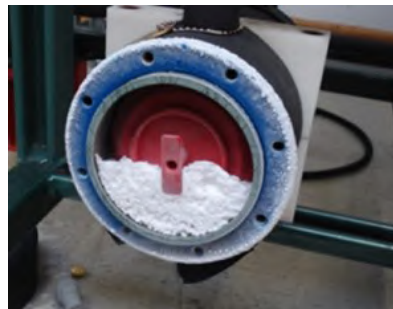
Figura 77 – Exemplo da formação de gelo seco em uma secadora
