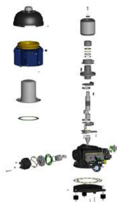
Figura 222 – Vista explodida do compressor semiaberto com tampa de separação
