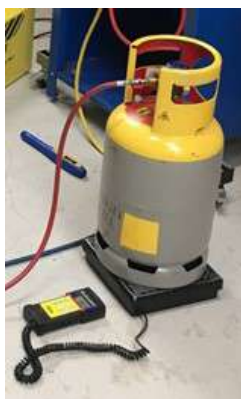
Figura 482 – Cilindro de recolhimento para gases inflamáveis conforme o ADR/TPED
