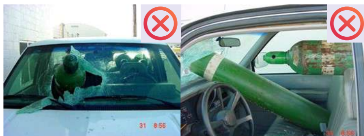
Figura 187 – Transporte inadequado de cilindros de gás não presos dentro de uma van, levando a um acidente
