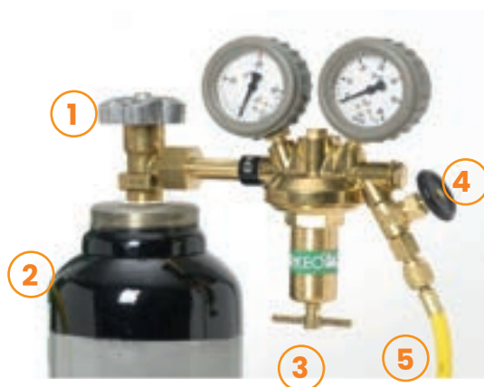
Figura 140 — Organização do equipamento para o teste de pressão
