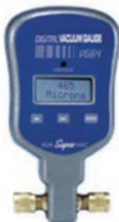
Figura 147 — Indicação de vácuo profundo com um vacuômetro eletrônico
