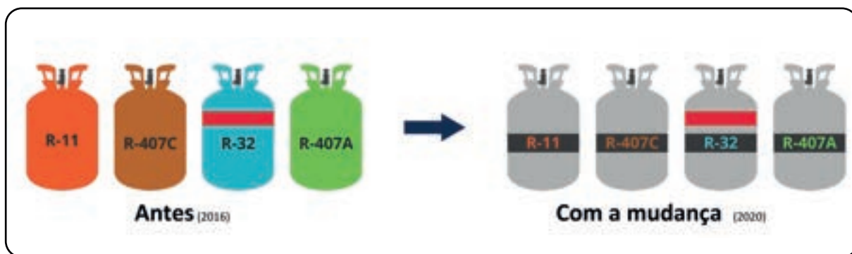
Figura 166 — Código de cores dos cilindros de acordo com a Diretriz N da AHRI
