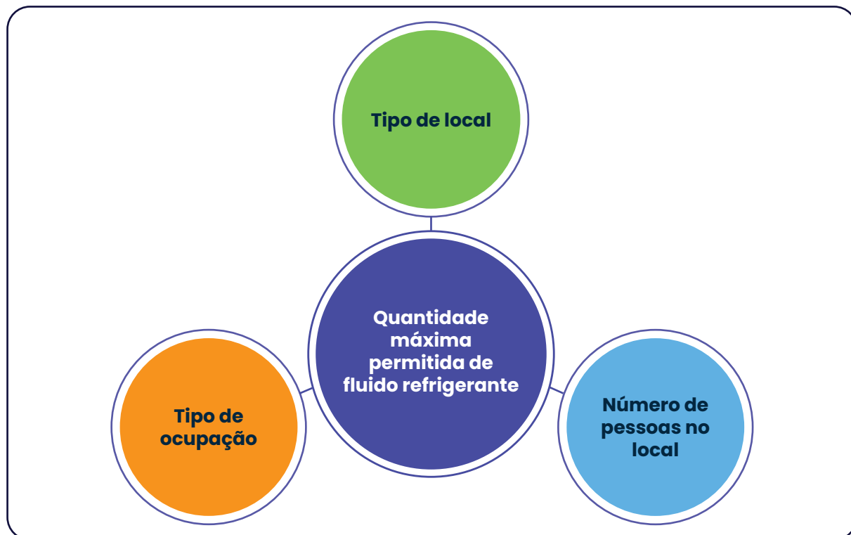
Figura 106 — Parâmetros determinando a quantidade máxima de fluido refrigerante inflamável
