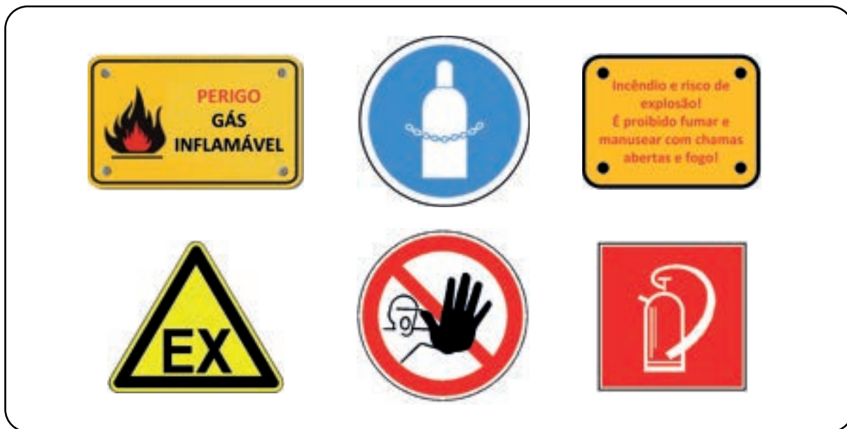
Figura 177 — Exemplos de sinalização para armazenamento de gases inflamáveis
