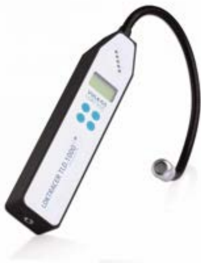
Figura 129 — Detector de gás eletrônico para uso com gás marcador (95% N 2 e 5% H 2 )
