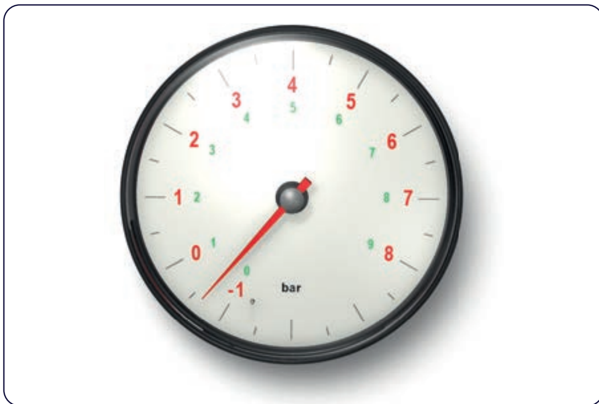
Figura 18 — Manômetro indicando pressão absoluta e sobrepressão
