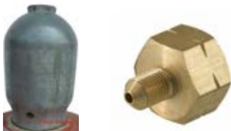
Figura 168 — Tampa de proteção da válvula do cilindro (esquerda) e adaptador do cilindro para conexão da mangueira de carga com a marcação entalhada ( gás inflamável ) (direita)
