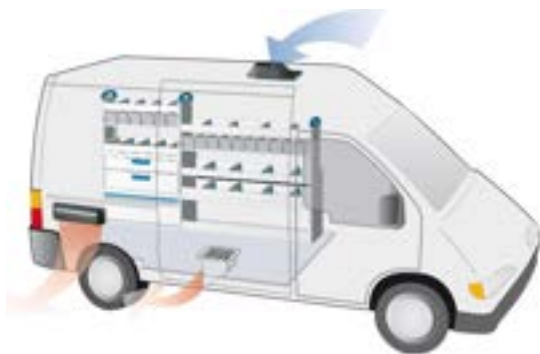
Figura 181 — Sistema de entrada de ar
