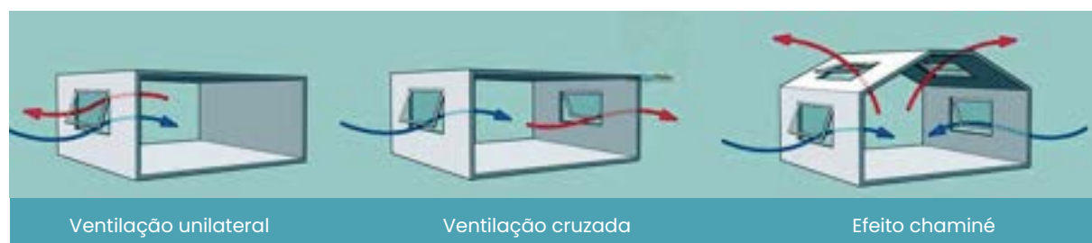
Figura 115 — Princípios da ventilação natural
