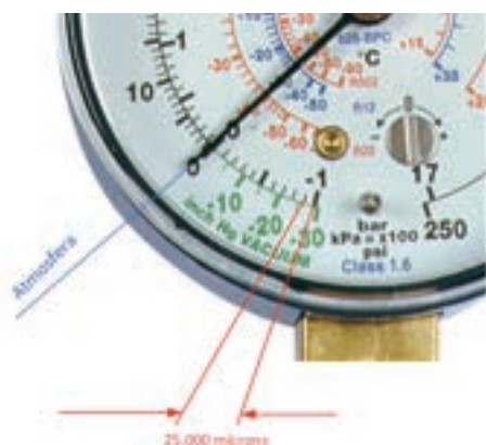
Figura 148 — Indicação de vácuo em um manômetro analógico de pressão
