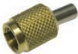
Figura 125 — Vazamento de referência para teste de detector portátil de gás
