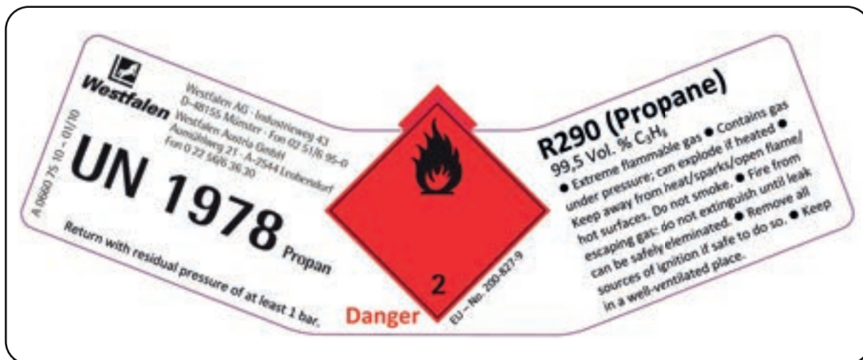
Figura 185 — Exemplo de etiqueta em cilindro de fluido refrigerante para o R-290
