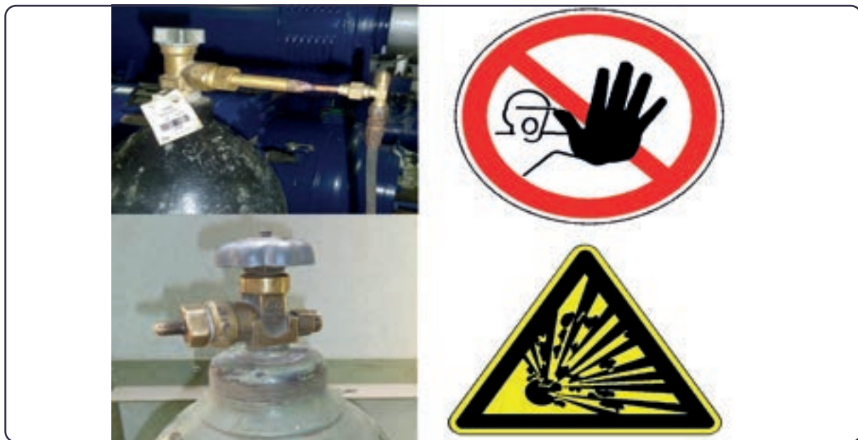
Figura 139 — Interferência proibida em cilindro de OFDN
