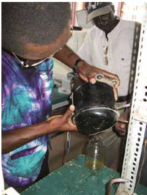
Imagem 14: Drenagem de óleo de um compressor hermético.
