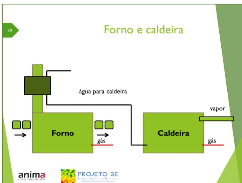
Neste sistema conjugado de forno e caldeira, aproveitou-se o calor residual de combustão do forno para pré-aquecer a água de reposição da caldeira. Como medir o resultado? Que opções podem ser usadas?
