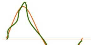
Alguns equipamentos eletrônicos “cortam” a corrente alternada, gerando uma distorção na forma de onda senoidal do gerador. Matematicamente, estes efeitos podem ser computados por uma série de Fourier, com senoides de frequência múltipla da rede, os chamados “harmônicos”. Os harmônicos podem prejudicar o funcionamento dos aparelhos ligados à rede.
