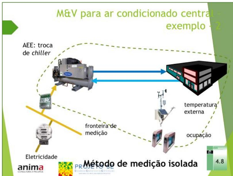
Caso haja fatores estáticos difíceis de monitorar, pode-se instalar um medidor de eletricidade exclusivo para o *chiller* (ou sistema de ar condicionado). As variáveis independentes podem ser as mesmas.
