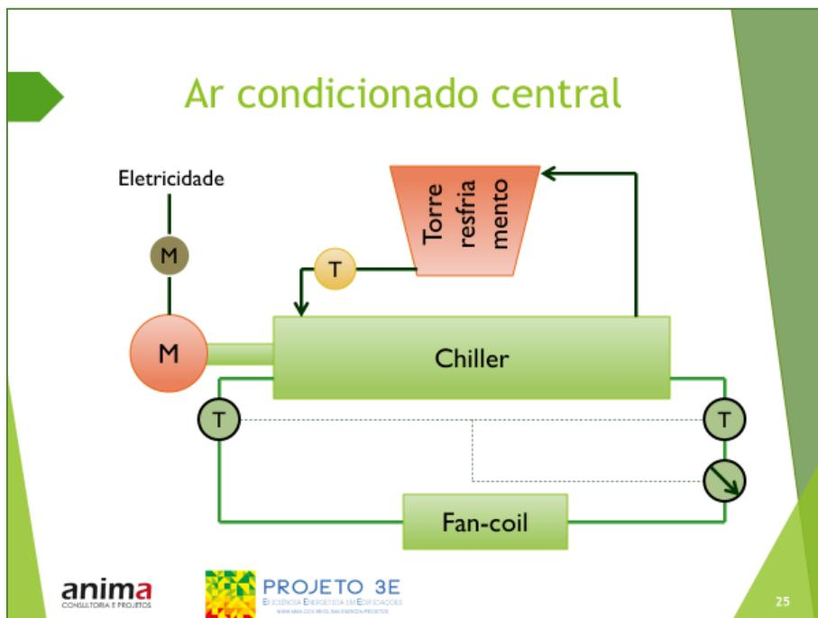
Em um sistema central, um resfriador (*chiller*) gera água gelada que circula pelos ambientes a resfriar. Esta água troca calor com o ar ambiente, circulando em serpentineas e ajudado por ventiladores (*fan-coil*). A condensação do refrigerante é feita por outro circuito d'água, chamada de condensação que, por sua vez, troca calor com o ar ambiente em uma torre de resfriamento.
