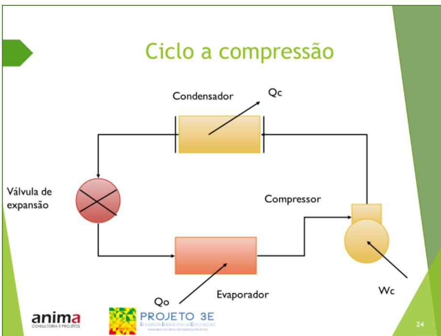
Todos esses são baseados no ciclo a compressão de um refrigerante (existe também o ciclo de absorção, que segue outro princípio para retornar o refrigerante à condição inicial). No ciclo à compressão, um líquido refrigerante passa por um pequeno orifício (válvula de expansão) expandindo-se para se tornar um gás e absorvendo calor do ambiente. Para reaproveitar o refrigerante, ele é comprimido e depois refrigerado no condensador, voltando à condição de
