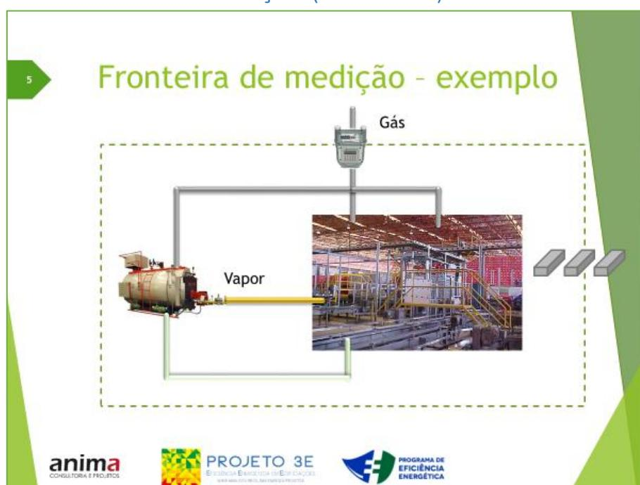
Esta sequência de slides exemplifica a definição da fronteira de medição. Imagine-se uma caldeira a gás, onde foi aplicada uma AEE, que fornece vapor para uma fábrica de papel. Evidentemente, o vapor gerado depende da produção, que é a variável independente. Podemos medir a energia por meio do medidor da concessionária de gás, desde que haja uma
