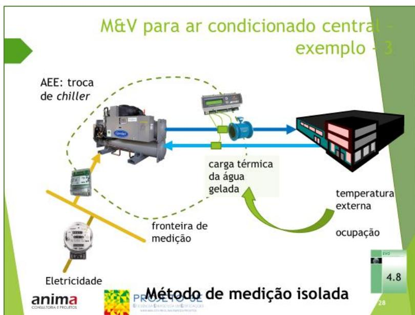
Se, ainda assim, os fatores estáticos atrapalham, pode-se medir diretamente a carga térmica da água gelada, restringindo a fronteira de medição. A variável independente passa a ser a carga térmica e vai absorver todas as variações do sistema, como temperatura externa, ocupação, mudança de leiaute, etc.
