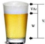
Simples resistências têm fator de potência próximo da unidade. Equipamentos com bobinas, usadas para aproveitar o efeito magnético da corrente, têm fator menor que um. Existem também os capacitores, cujo efeito à rede é complementar ao dos que contêm bobinas.
