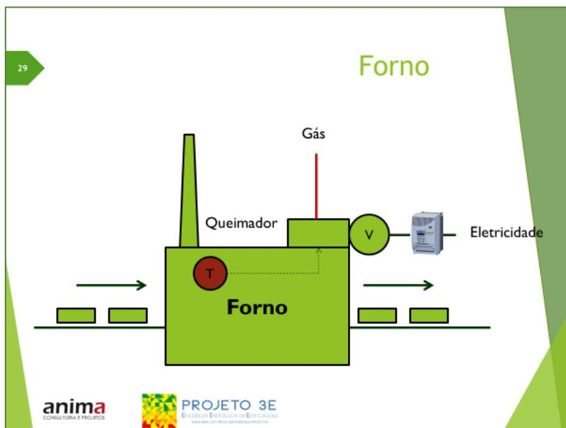
Em um forno industrial, mantido a temperatura constante, instalou-se um AVA (acionador de velocidade ajustável) para diminuir a velocidade do ventilador quando o forno está em baixa carga. Como medir o resultado da AEE? Quais os efeitos interativos?
