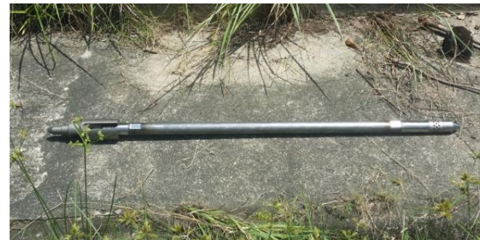
Figura 1: Esquema da ferramenta Direct Push Injection Logger (DPIL). Fonte: Dietrich et al. (2008).
