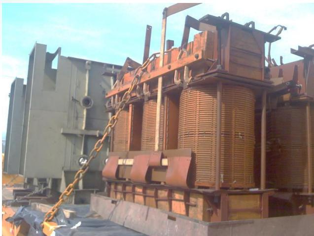
**Un 5% de la recontaminación del aceite nuevo proviene de los materiales porosos que componen el núcleo**
