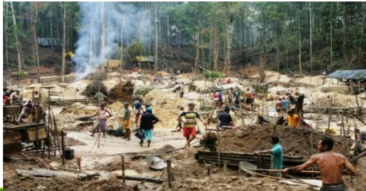
**Garimpo de margem:** feito com peneiras manualmente em córregos, destrói a mata ciliar do local e também há o decapamento (retirada do solo). Expansão do território de extração usando as lavras (cortes no solo).
