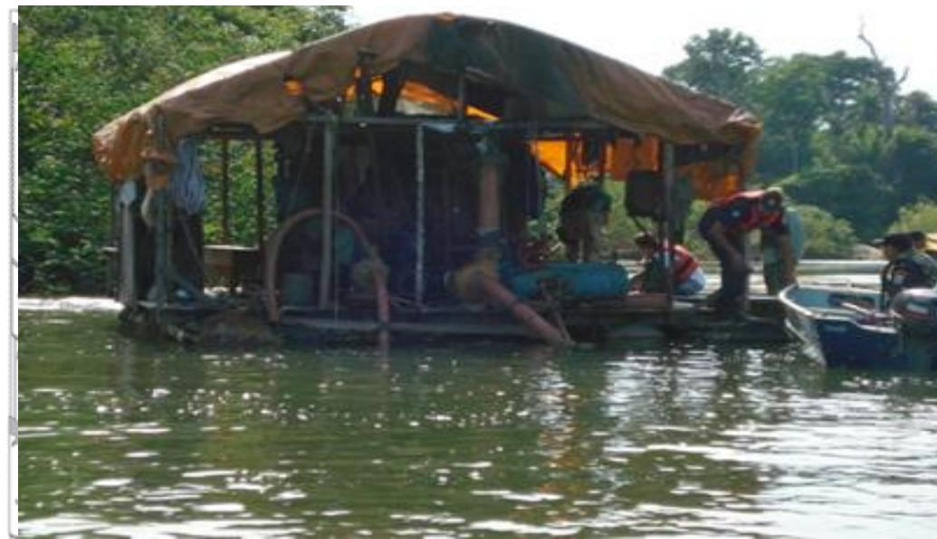
**Garimpo de leito:** manual ou com uso de dragas. No manual o garimpeiro escava o leito do rio, pega o material escavado e faz o processo de peneiração para separar os minérios. Com uso de draga a escavação é mais ágil, o material cai numa peneira que separa o minério da lama e água. O garimpeiro recolhe o minério.
