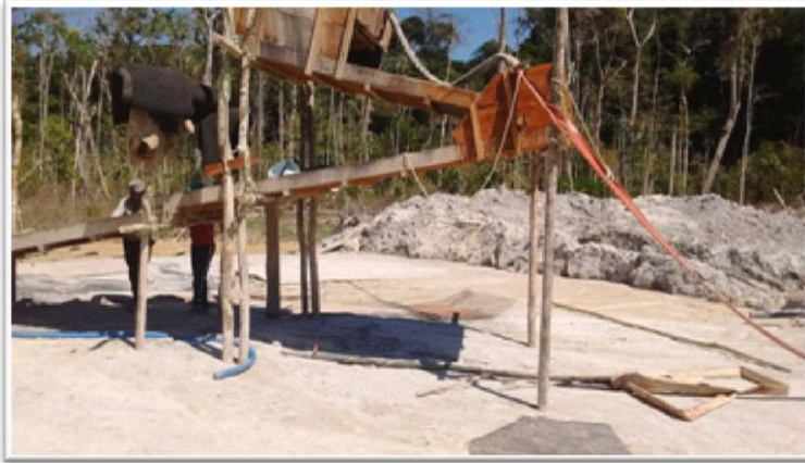
Foto 13. Calha riflada para a concentração gravítica do ouro
