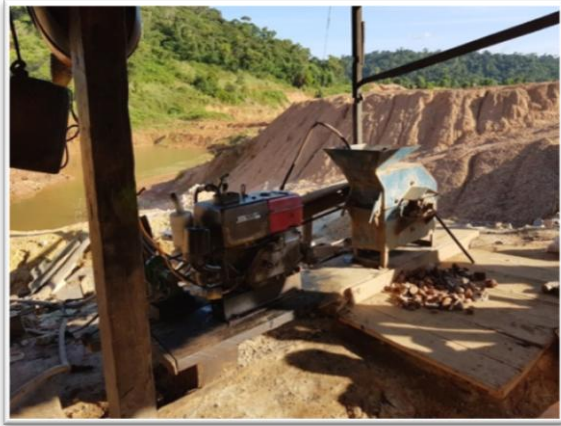
Foto 45. Rejeito de minério garimpado por faisqueiros para ser moído em moinho de martelo
