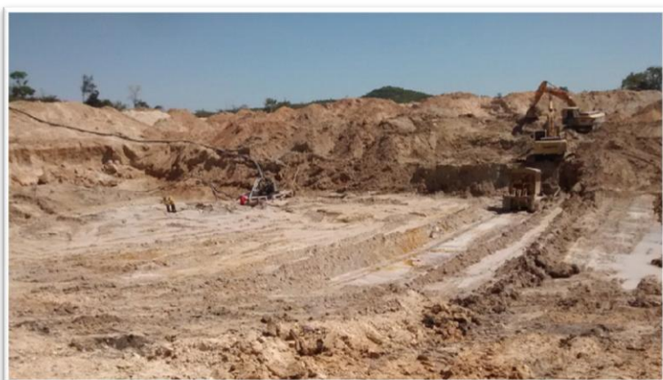
Foto 3. Sistema de lavra, de maior porte (em relação a foto anterior), do minério secundário, com escavadeira
