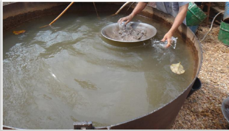
Foto 31. Outro modelo de tanque para bateamento do amálgama
