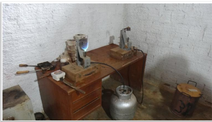
Foto 35. Retorta para recuperação de Mercúrio durante a decomposição térmica do amálgama, em sala de alvenaria, fechada, com aberturas na parte superior das paredes
