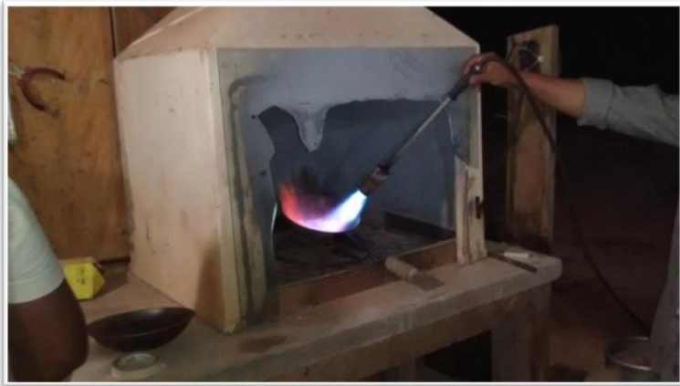
Foto 38. Capela com sistema para recuperação de Mercúrio durante a decomposição térmica do amálgama
