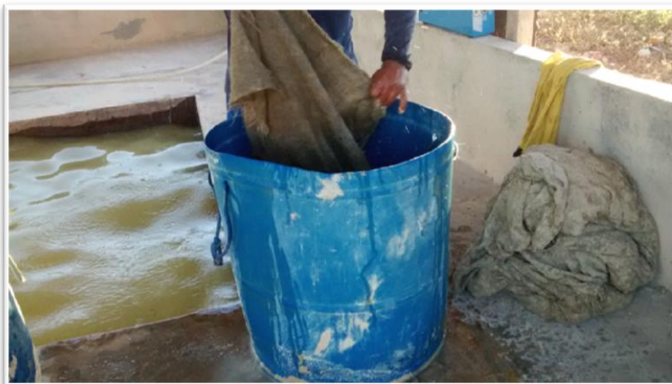
Foto 15. Retirada dos tapetes da calha riflada com o concentrado sendo contido em tambor
