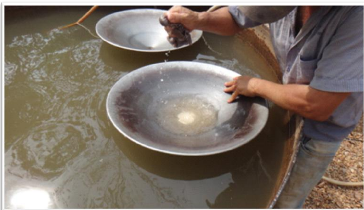
Foto 32. Recuperação do Mercúrio pela técnica de “filtragem” em pano
