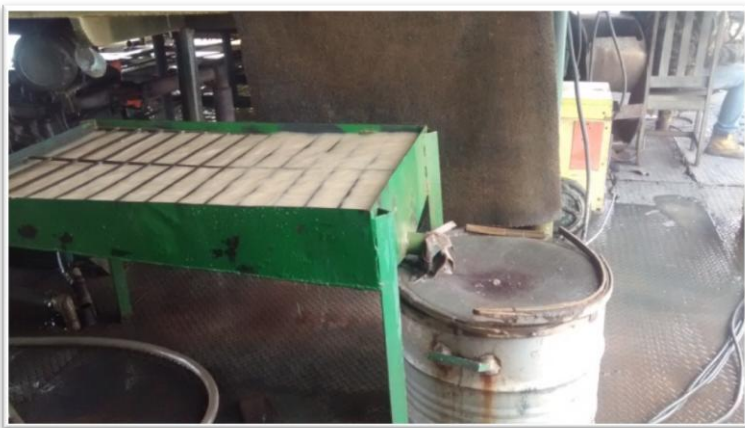
Foto 11. Sistema de concentração de minério em draga de leito de rio
