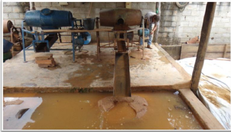
Foto 19. Central de Amalgamação, com tambores amalgamadores
