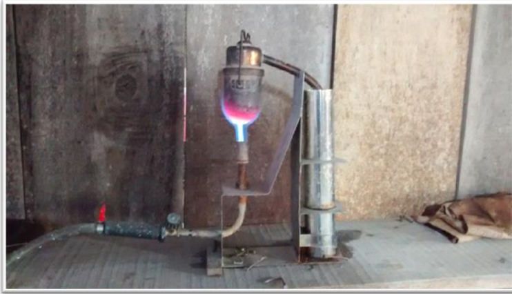
Foto 34. Retorta para recuperação de Mercúrio durante a decomposição térmica do amálgama em Central de Amalgamação. Como consta apenas uma parede, de madeira, está é considerada aberta
