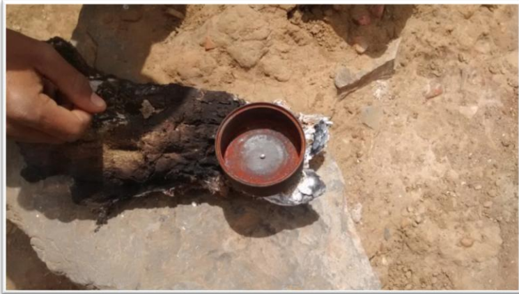
Foto 29. Queima do alalgama resultante da placa amalgamadora
