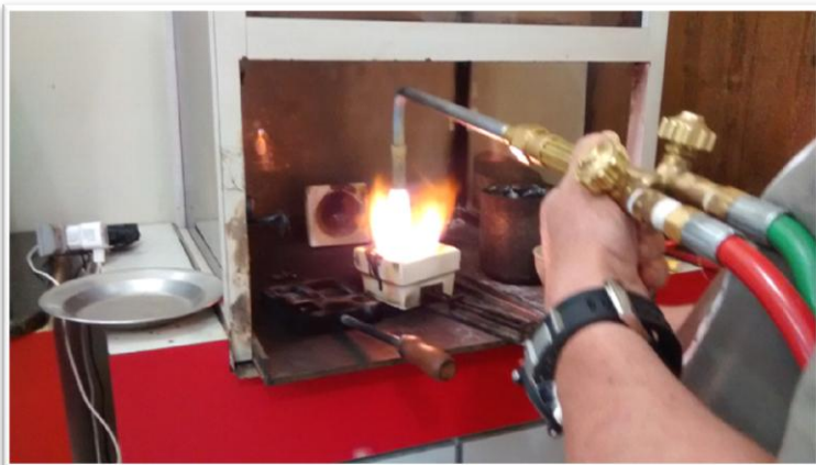
Foto 42. Segunda queima realizada em capela, em casa de compra de ouro
