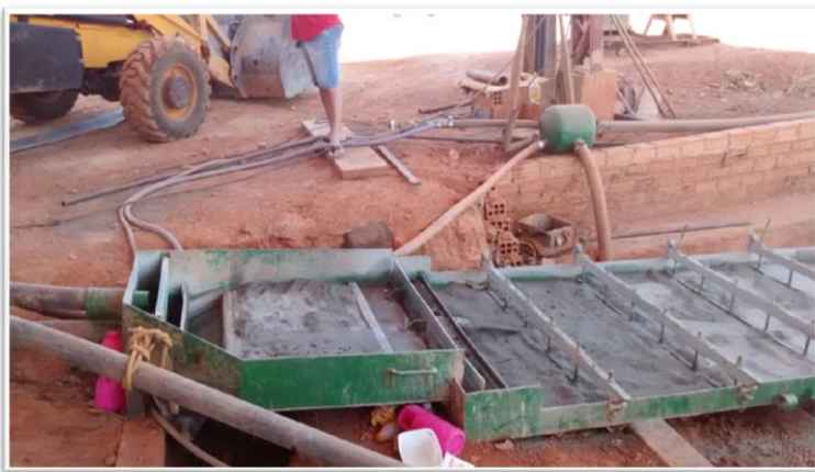
Foto 23. Sistema de placas amalgamadoras que recebem os rejeitos do minério secundário processado e o minério primário, britado e moído em moinho de martelo
