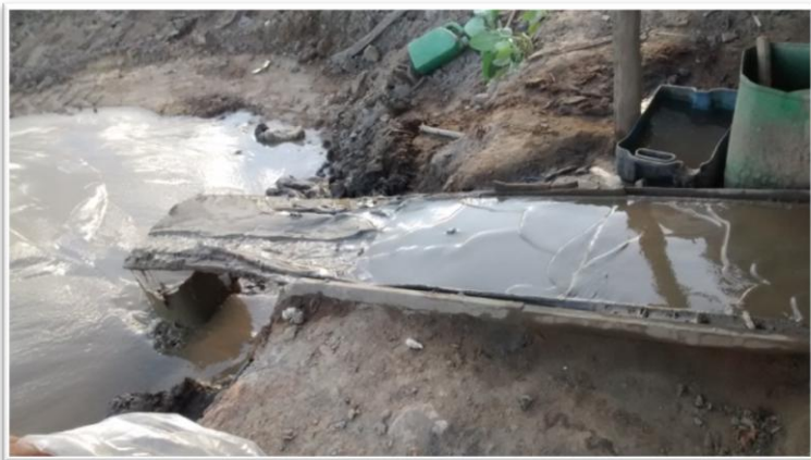
Foto 27. Rejeito da palca amalgamadora
