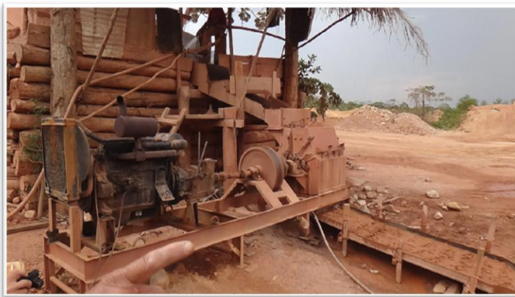
Foto 20. Moinho de martelo para processamento de minério primário e calha riflada
