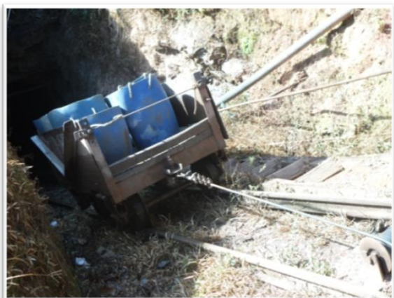
Foto 7. Mina subterrânea de minério primário com acesso por plano inclinado
