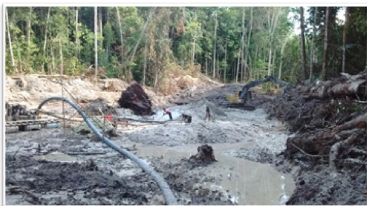
Foto 2. Sistema de lavra do minério secundário: escavadeira e desmonte hidráulico com uso de jato d'água, draga e mangueiras para envio da polpa às calhas rifladas, concentradoras
