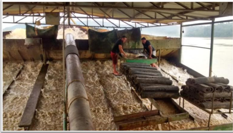
Foto 10. Calha riflada em draga de leito de rio
