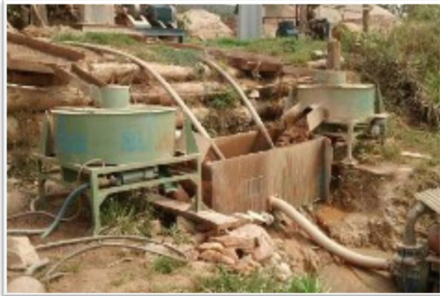
Foto 22. Centrífuga ao final de calha riflada para recuperação de ouro fino
