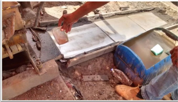
Foto 25. Utilização de água na placa amalgamadora
