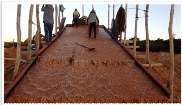
Foto 14. Detalhe de uma calha riflada de maior porte (em comparação a foto anterior)
