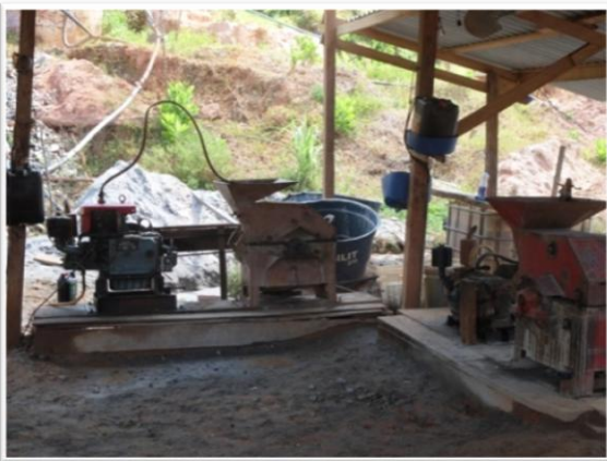
Foto 21. Moinho de martelo para processamento de minério primário
