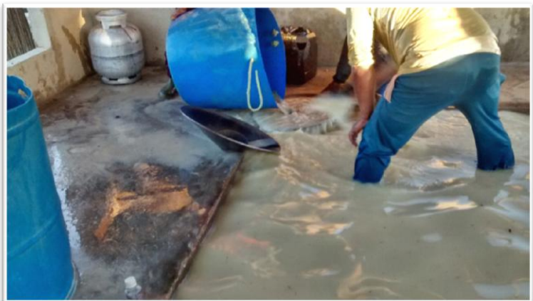
Foto 18. Bateamento do amálgama em tanques de contenção na Central de Amalgamação
