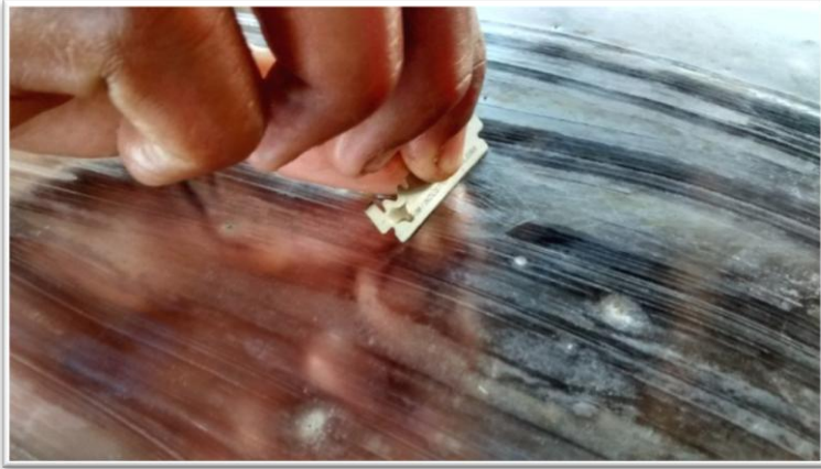
Foto 28. Raspagem da placa amalgamadora
