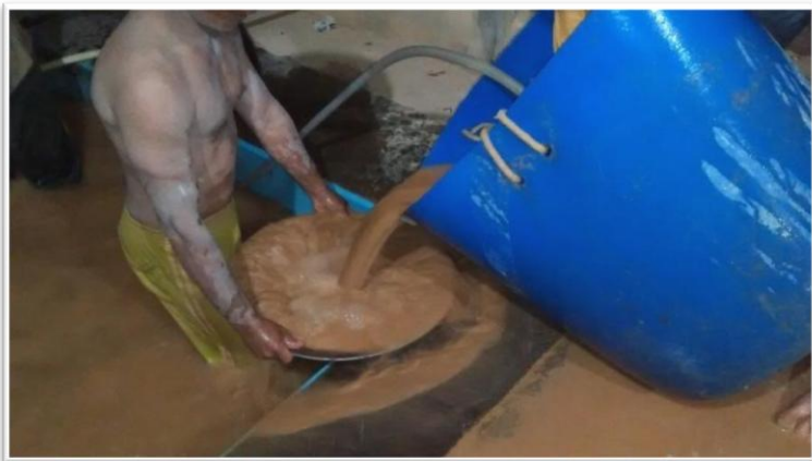
Foto 8. Tanque para bateamento do amálgama em uma Central de Amalgamação
