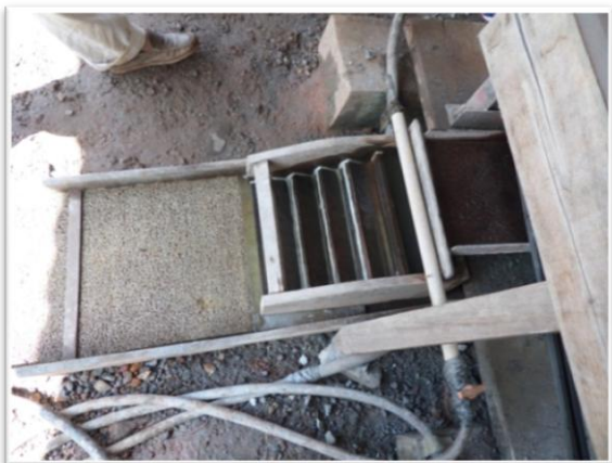
Foto 16. "Cochim" e calha com carpete utilizada para concentração do minério
