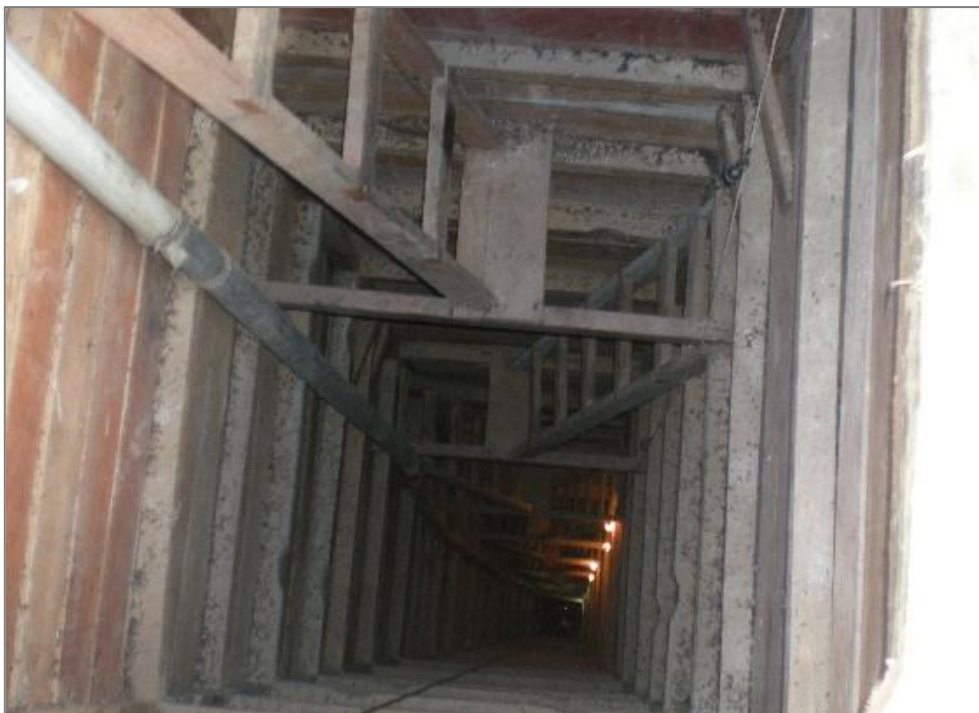
Figura 5. Shaft escorado com madeira utilizado no processo de extração de ouro primário
