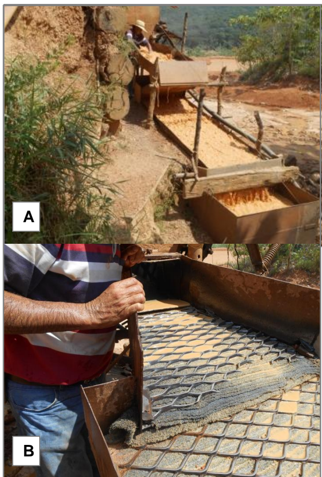
Figura 6. (a) calha e caixa concentradoras; (b) carpete sob aletas para retenção do ouro
