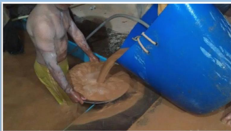
Retirada dos tapetes da calha riflada com o concentrado sendo contido em tambor e adição de Hg
