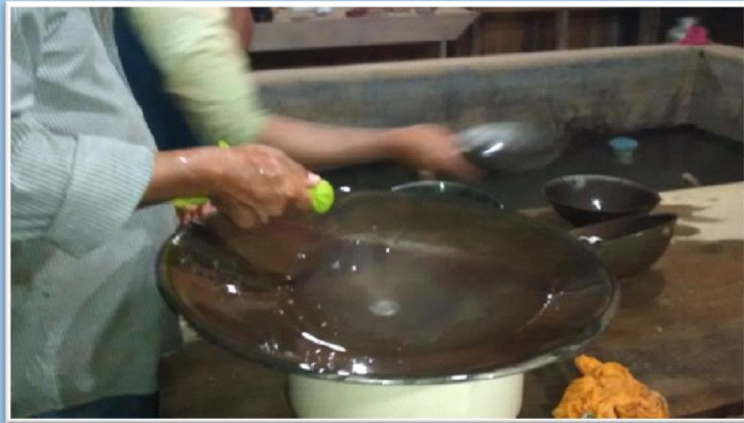
Recuperação do Hg por “filtragem” em pano
