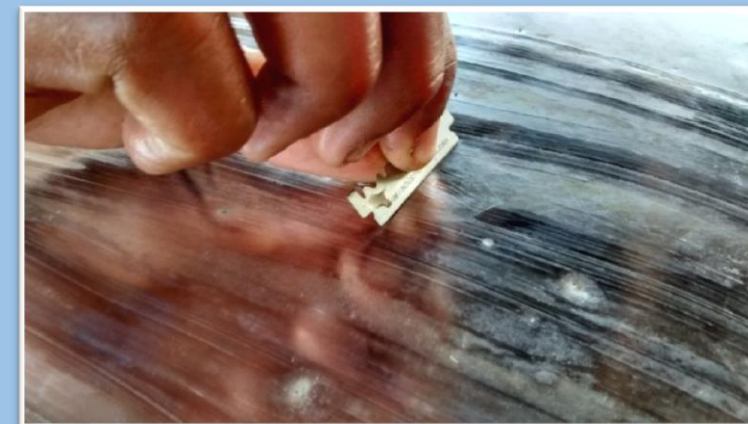
Raspagem da placa amalgamadora
