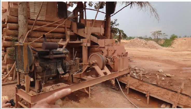
Moinho de martelo para processamento de minério primário e calha riflada para concentração
