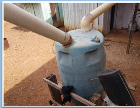
Sistema de captação de Hg em capela
