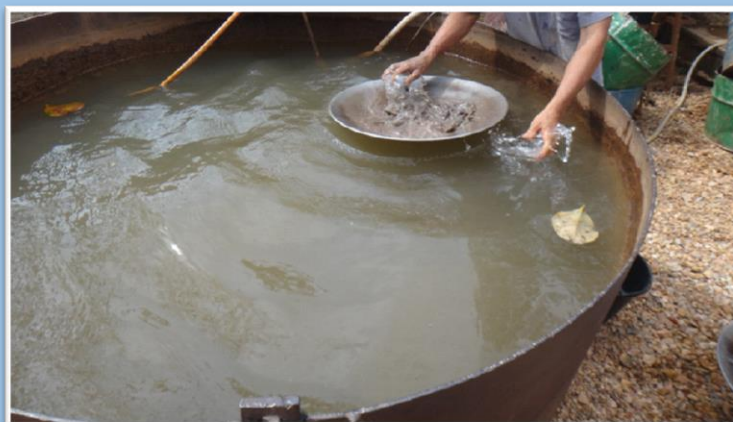
Tanque para bateamento do amálgama em uma Central de Amalgamação (CA)
