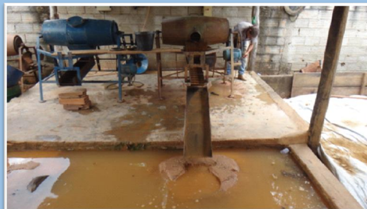
CA com tambores amalgamadores e bacia de contenção de rejeitos
