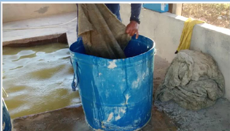
Retirada dos tapetes da calha riflada com o concentrado sendo contido em tambor e adição de Hg
