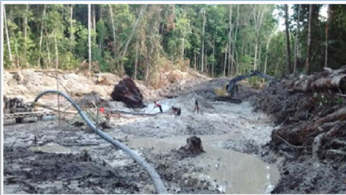
minério secundário: escavadeira e uso de jato d'água e de mangueiras para envio da polpa às calhas rifladas
