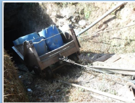
Mina subterrânea de minério primário com acesso por plano inclinado
