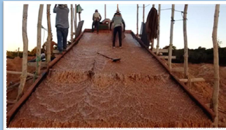
Concentração de minério secundário em calha riflada
