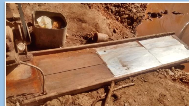
Placa amalgamadora (após moinho de martelo)
