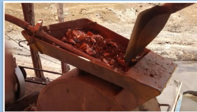
Moinho de martelo para processamento de minério primário, sem concentração
