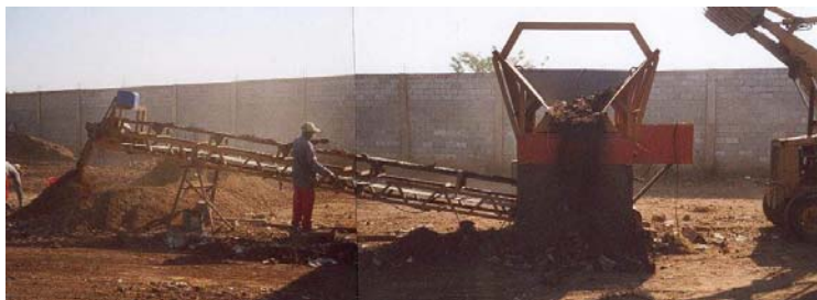
Figura 13 – Recuperação da parcela fina de resíduos de construção em Guarulhos / SP.
