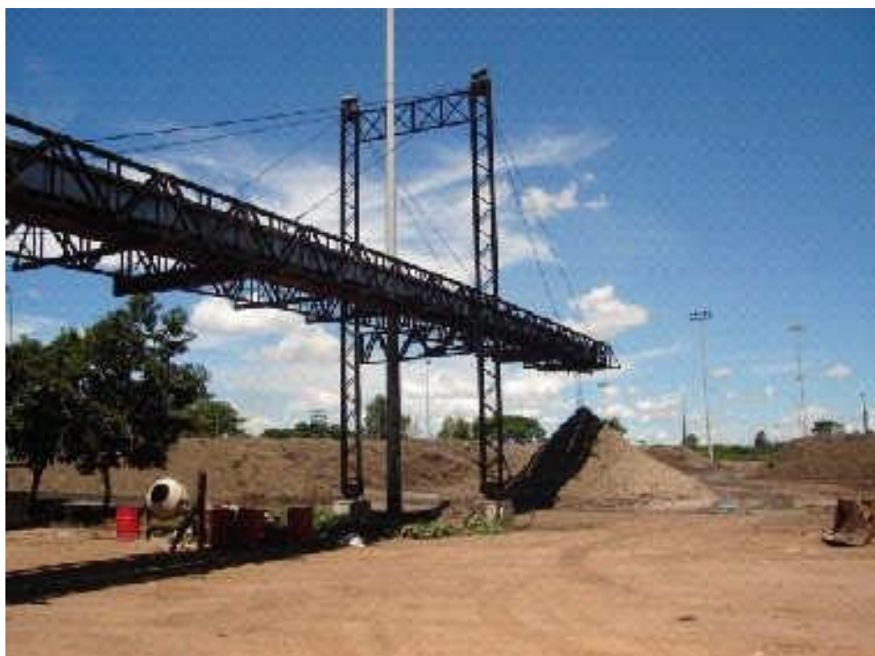
Figura 9 – Esteira rolante de resíduos orgânicos para a compostagem – Tecnologia Triga Fonte: Plano Diretor de Resíduos Sólidos do Distrito Federal - 2009
