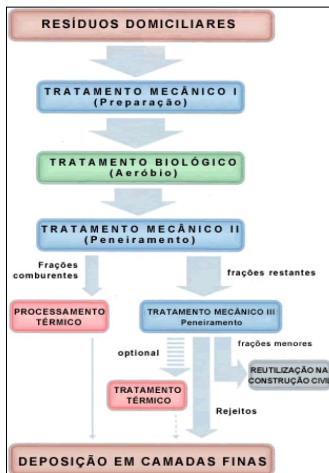
Figura 16 – TMB - Fluxo dos resíduos - Sistema Faber – Ambra
