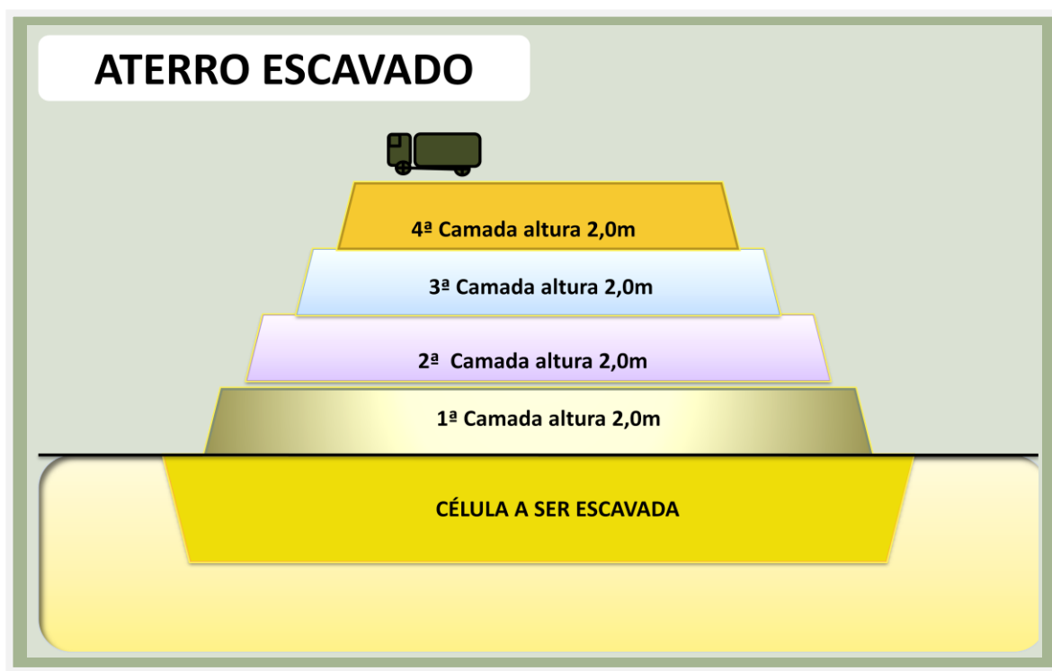
Figura 6.6: Esquema da estrutura de uma célula no aterro sanitário
